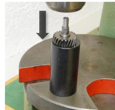
1. Снимите шарикоподшипник.
