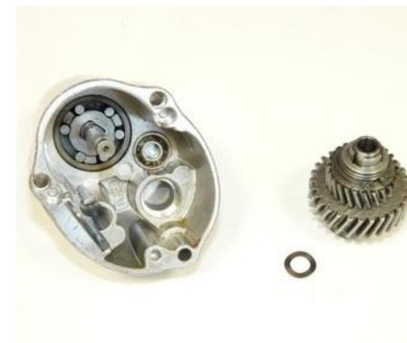
1. Снимите шарикоподшипник.
