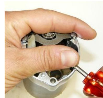
1. Снимите пластину.
