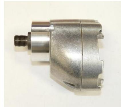
1. Remplir l'engrenage de graisse (12 g).
