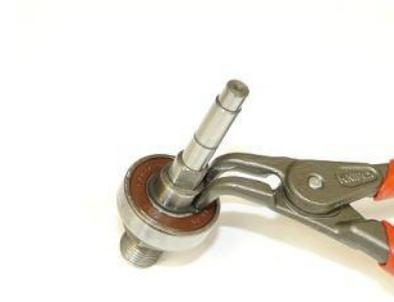
1. Appuyer sur l'arbre et le roulement à billes pour les extraire du carter d'engrenage.
