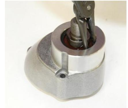
1. Retirer la roue cylindrique et le disque de ressort.
