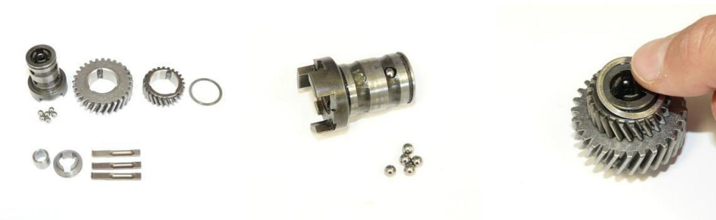
1. Lubrifier les orifices de l'entraîneur avec un peu de graisse.
