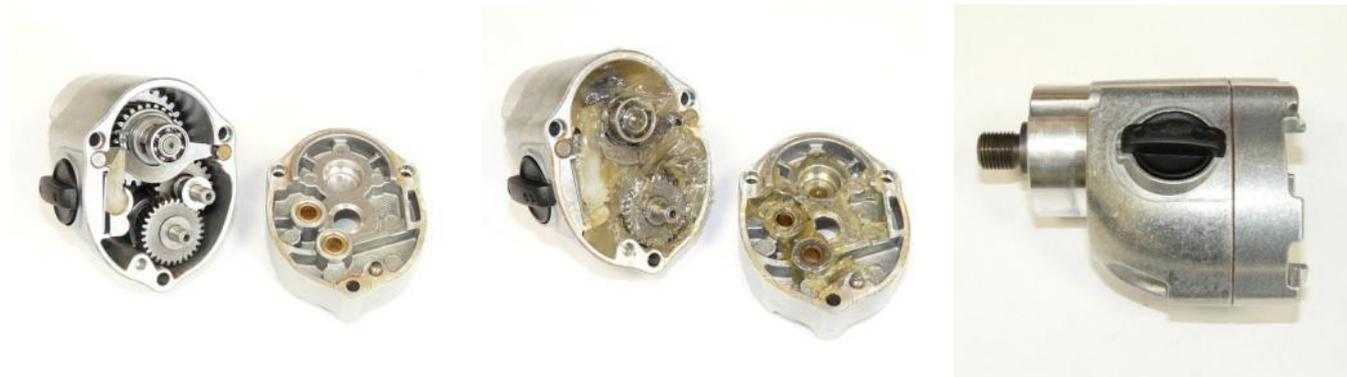
1. Remplir l'engrenage de graisse (25 g).
