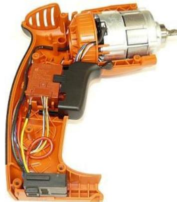
1. Insérer le connecteur par pincement dans la partie inférieure du carter.
