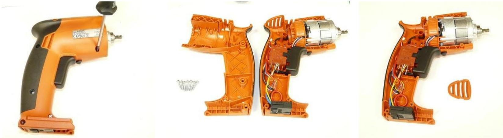
1. Desserrer les vis de la partie supérieure du carter et retirer la partie supérieure du carter.
