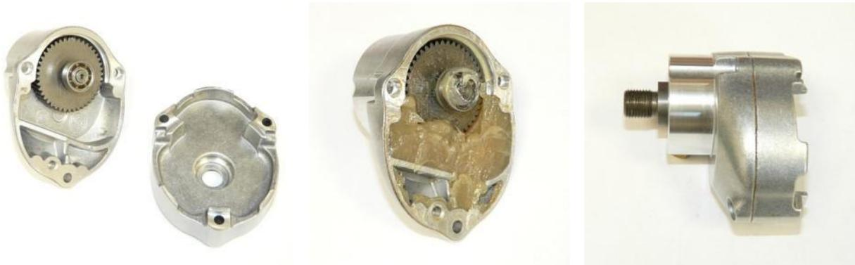
1. Remplir l'engrenage de graisse (12 g).
