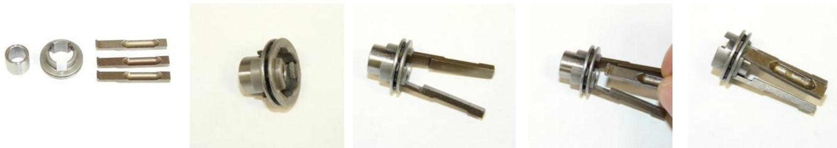
1. Appliquer un peu de graisse dans les évidements (pour les clavettes de retrait) de la douille de guidage.
