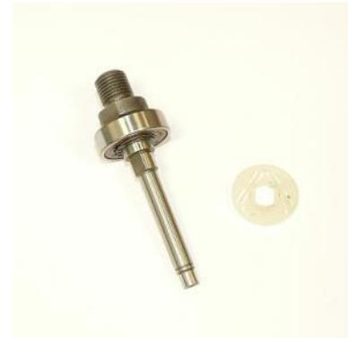
1. Welle zusammen mit dem Kugellager aus dem Getriebekopf pressen.
