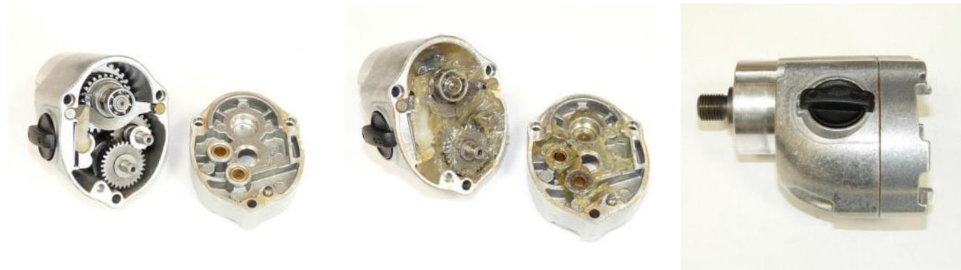
1. Getriebe mit Fett befüllen ( 25 g).
