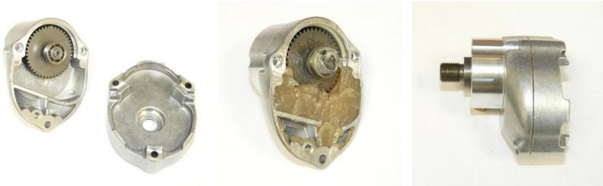
1. Getriebe mit Fett befüllen ( 12 g).
