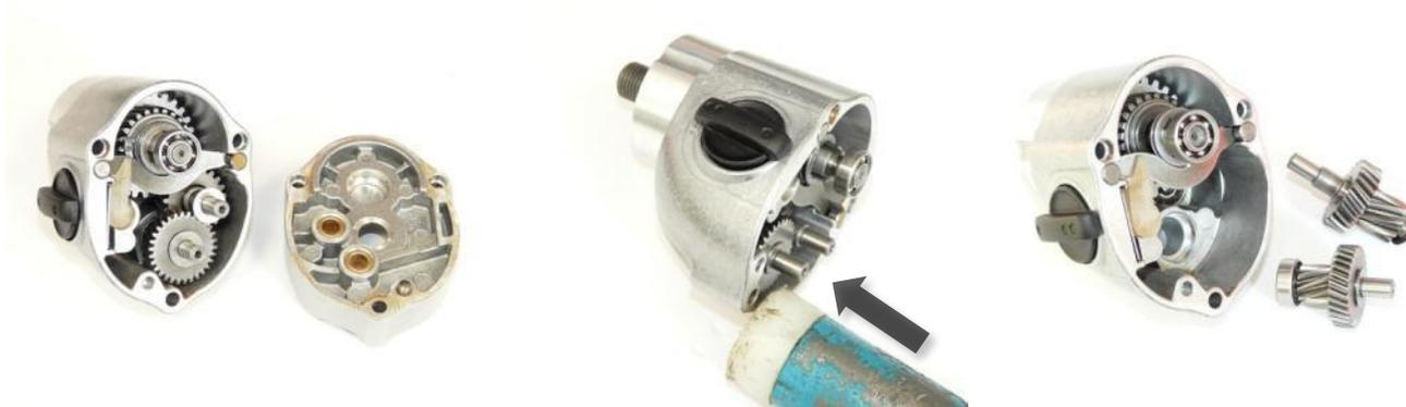
1. Zwischenlager vom Getriebekopf herunterhebeln.
