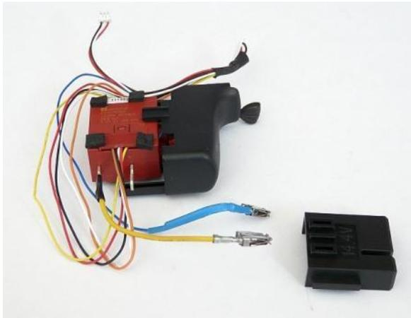
1. Die Schalterkabel mit dem Entriegelungswerkzeug aus dem Stecker herausdrücken.
