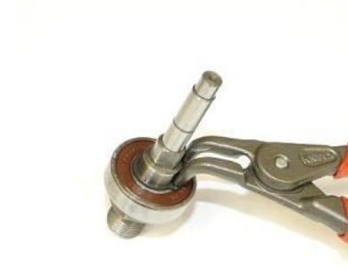
1. Welle zusammen mit dem Kugellager aus dem Getriebekopf pressen.
