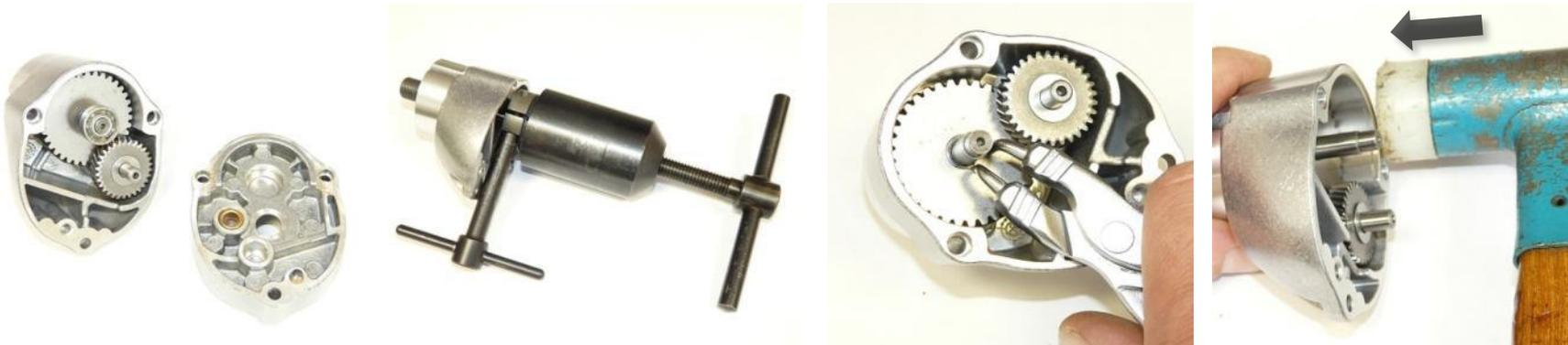
1. Zwischenlager vom Getriebekopf herunterhebeln.
