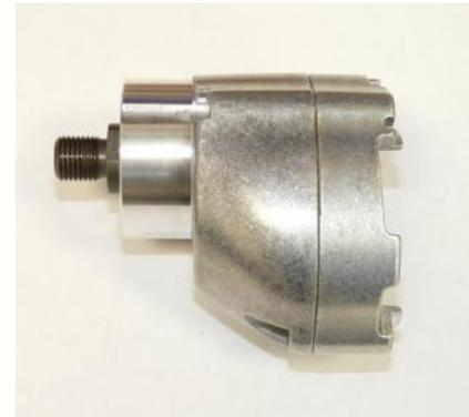
1. Getriebe mit Fett befüllen ( 12 g).
