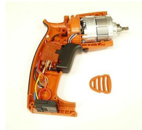
1. Schrauben am Gehäuseoberteil lösen und Gehäuseoberteil abnehmen.
