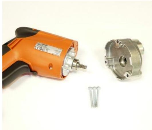
1. Schrauben am Getriebekopf lösen.
