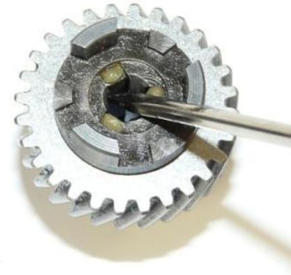
1. Sicherungsring montieren.
