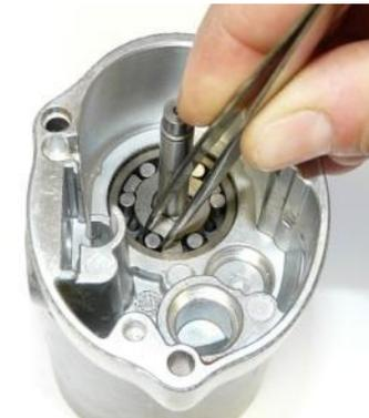
1. Kupplungsring einsetzen.
