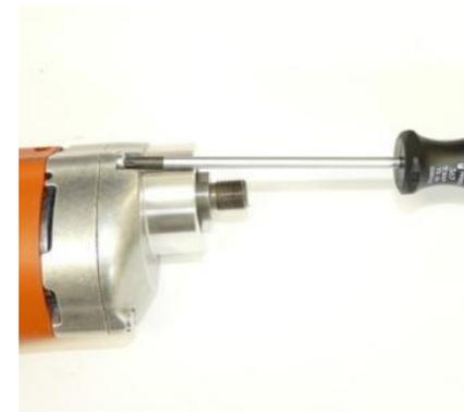
1. Gehäuseoberteil aufsetzen und festschrauben.
