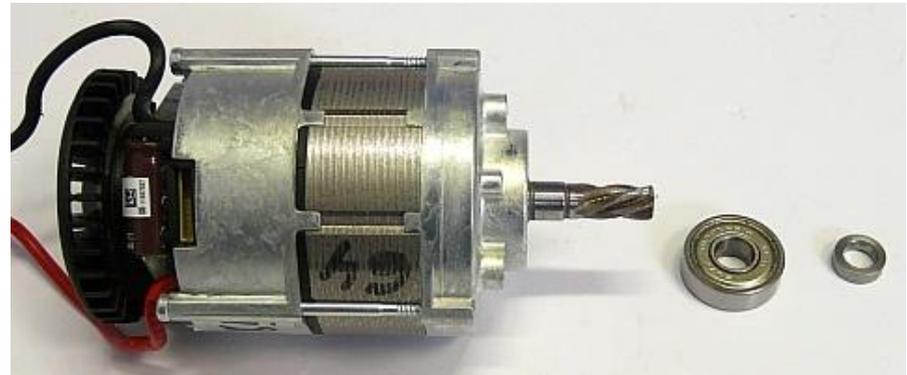
1. Kugellager und Dichtring vom Motor abziehen.
