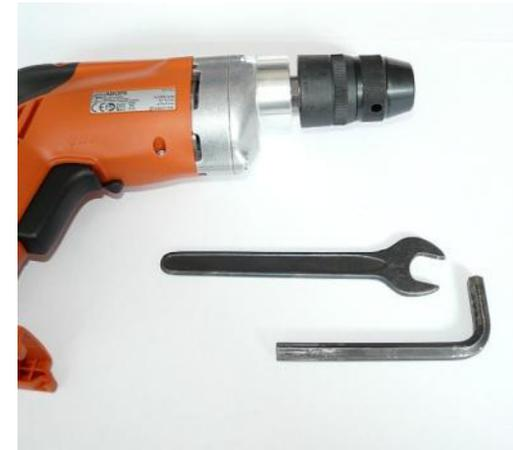
1. Bohrfutter aufsetzen und festschrauben.
