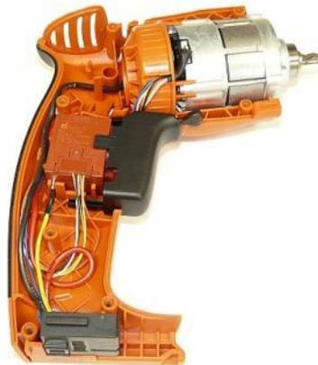
1. Klemmstück in das Gehäuseunterteil einsetzen.
