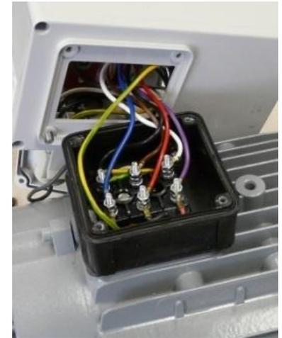
1. Desserrer les 4 vis de fixation du couvercle du boîtier de commande.
