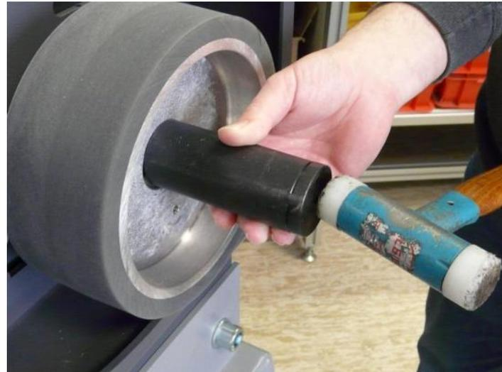
1. Avant de monter la roue d'entraînement, lubrifier l'extrémité de l'arbre moteur.
