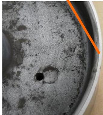
Les photos montrent un cas d'usure irrégulière de la roue d'entraînement due aux vibrations (rotation entravée), à la suite d'importants encrassements dus à la poussière de ponçage.
