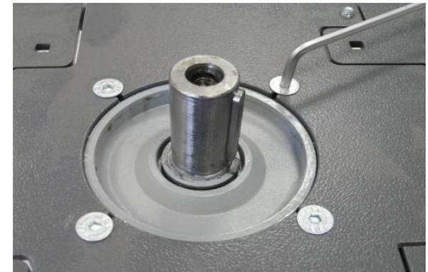
1. Desserrer les 4 vis de fixation du moteur.
