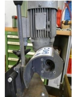
1. Innensechskantschraube lösen und Abdrückvorrichtung anschrauben
