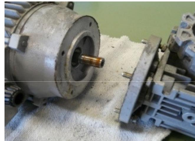
1. 4 Schrauben am Motorflansch lösen
