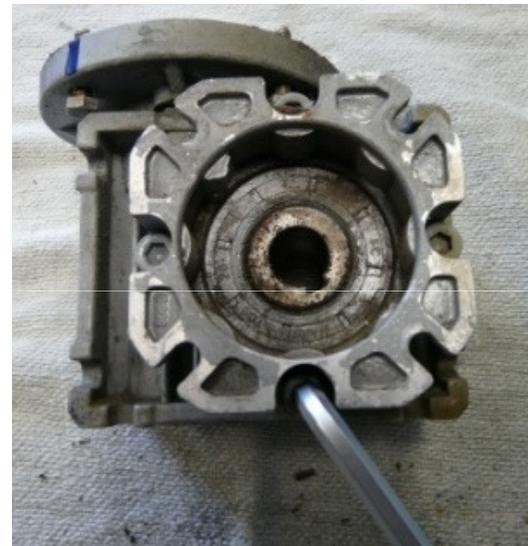
1. 4 Schrauben vom Motorflansch lösen und Flansch abnehmen
