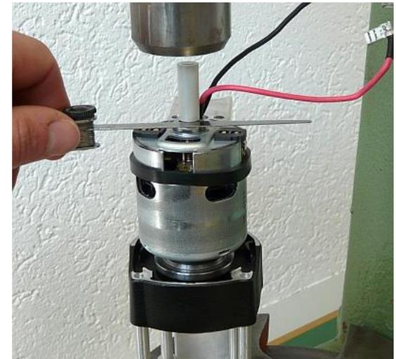
1. Insertar el anillo de tolerancia en el manguito del cojinete.
