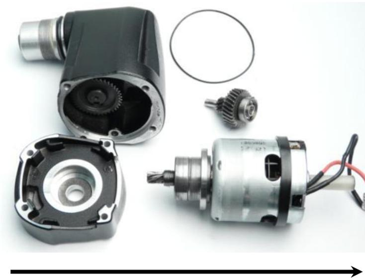
1. Sacar el cojinete intermedio del cabezal de engranaje.
