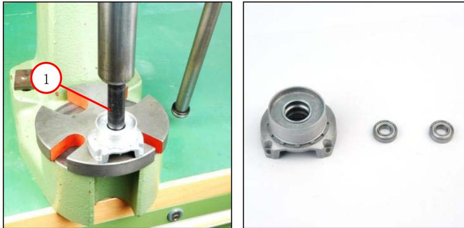
1. 使用轴套 (1) 和芯棒压力机压出第二个开槽球轴承。
