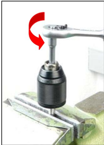
1. 将螺丝旋入快速夹紧钻夹头（向左旋转）。
