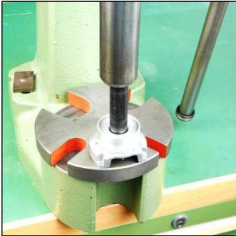
1. 将两个开槽球轴承分别压入外壳中的两侧。
