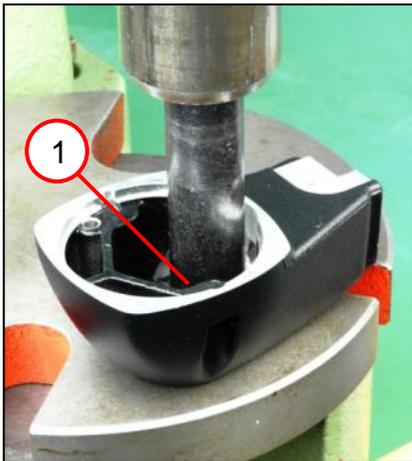
1. Das Rillenkugellager (1) in das Gehäuse einpressen.
