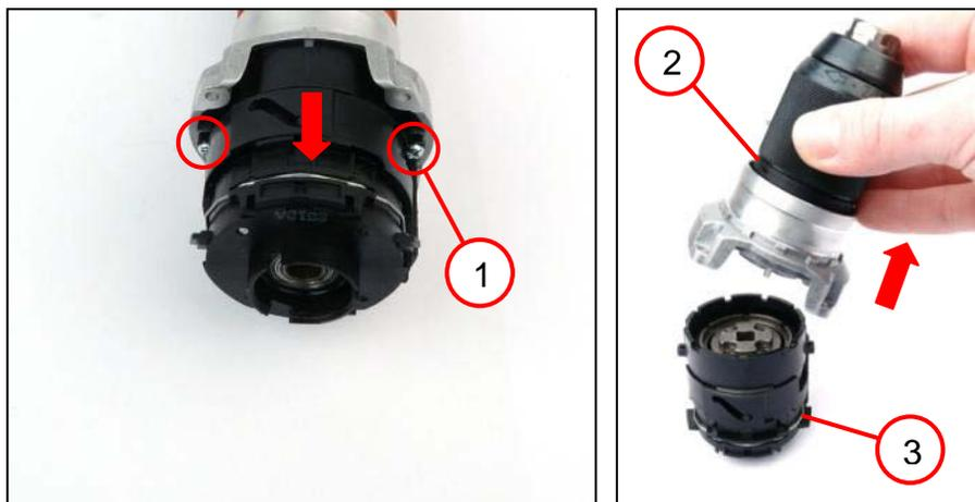
1. Desenroscar los dos tornillos (1) y extraer hacia arriba la carcasa (2).
