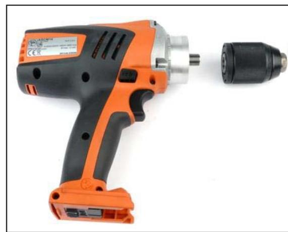
1. Desatornillar el tornillo del portabrocas de sujeción rápida (rosca a la izquierda).
