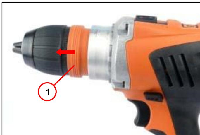
1. Presionar la parte inferior del portabrocas de sujeción rápida (1) y extraer el portabrocas de sujeción rápida de la atornilladora.
