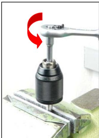
1. Enroscar el tornillo en el portabrocas de sujeción rápida (rosca a la izquierda).
