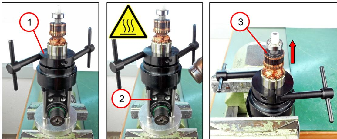
1. Colocar el dispositivo de desmontaje (1) en el inducido.
