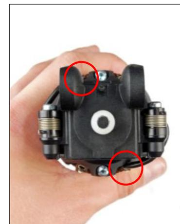
1. Colocar el soporte de la escobilla de carbón (1) en el estator y fijarlo con el tornillo (2) [ $1,5 \pm 0,1$  Nm].
