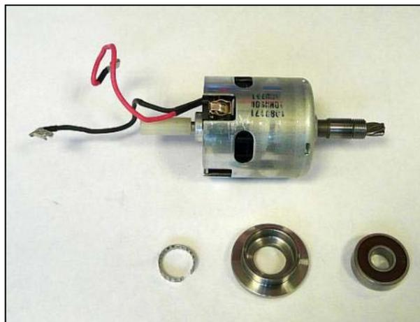
1. Снимите радиальный шарикоподшипник с двигателя.
