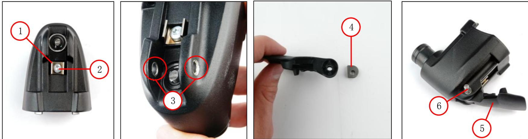
1. 使用半圆头埋头螺栓 (2) 固定止动弹簧 (1) ( $2.0 \pm 0.1\text{Nm}$ )。
