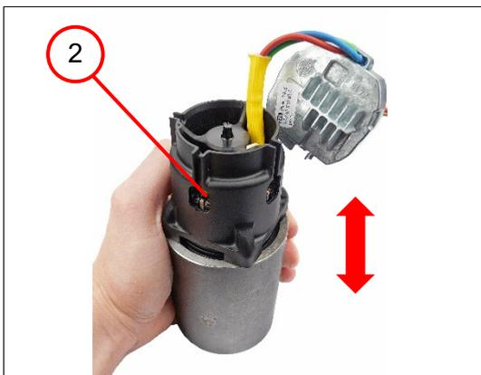
2. Den Stator (2) entfernen.
