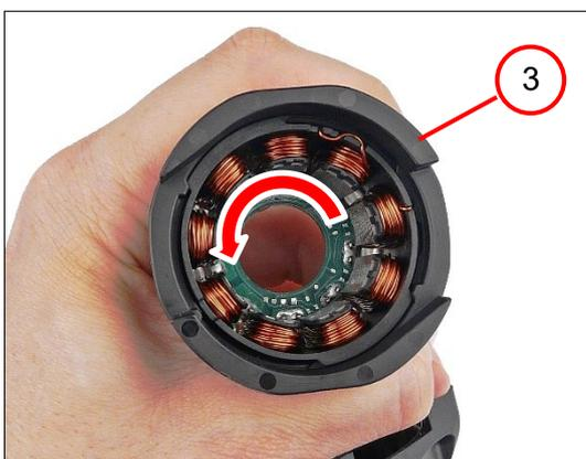
3. Den Luftleitring (3) gegen den Uhrzeigersinn drehen und entfernen.
