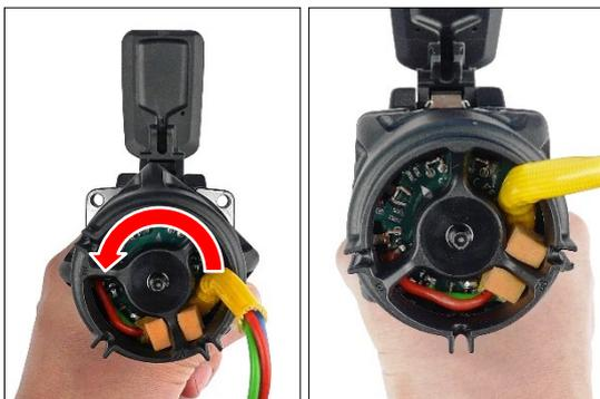
3. Das Gehäuse gegen den Uhrzeigersinn drehen.
