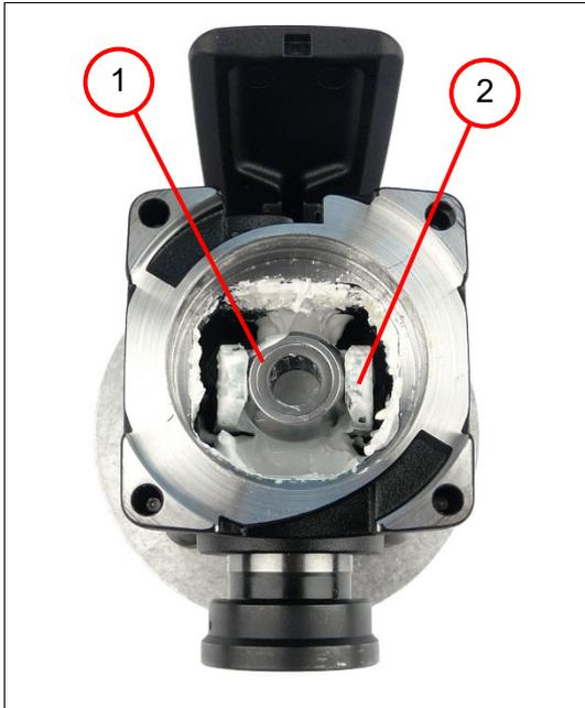
5. Den Maschinenkopf mit Fett befüllen.
