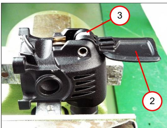
2. Den Hebel (2) entfernen.
