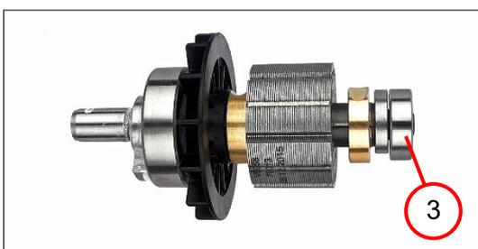
3. Das Rillenkugellager (3) entfernen.
