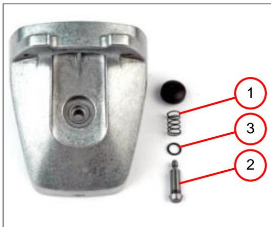
1. Installer le ressort spiral (1) et le boulon (2) avec la bague d'étanchéité (3).
