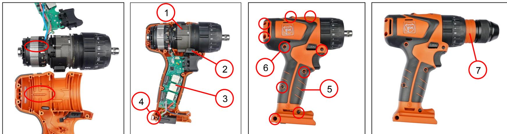
1. 将齿轮传动装置 (1) 安装在正确的位置上。
