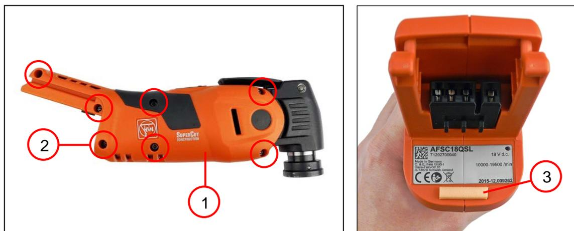
1. Colocar la mitad de la carcasa del motor (1).
