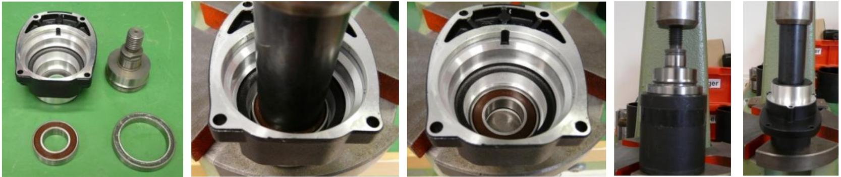
1. Kugellager in das äußere Lager einpressen.
