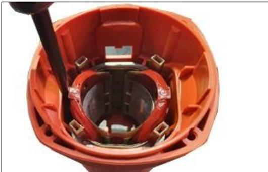
5. Die Kontaktfeder mit der Montagehilfe nachdrücken.
