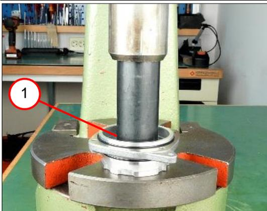
1. Das Rillenkugellager (1) einpressen.
