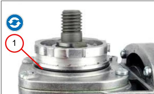
1. Den Dichtring (1) entfernen.
