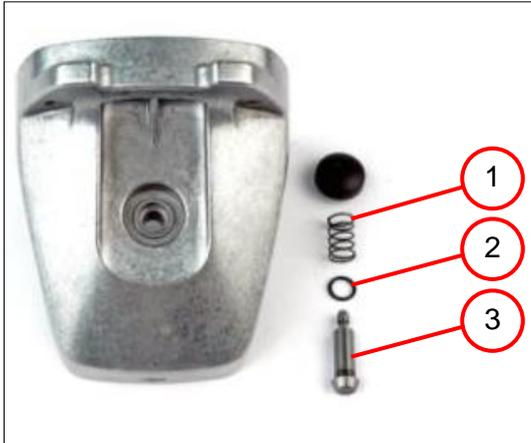
3. Die Spiralfeder (1) entfernen.
