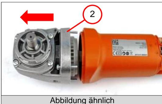
2. Das Getriebegehäuse (2) entfernen.
