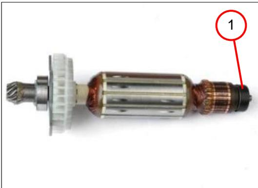
1. Die Lagerbuchse (1) entfernen.
