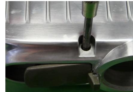
1. Insérer le boulon de guidage et fixer avec la vis
