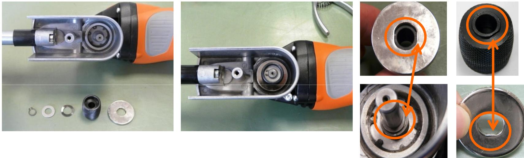
1. Placer la rondelle de distance, la roue d'entraînement avec disque de ressort et rondelle sur la broche
