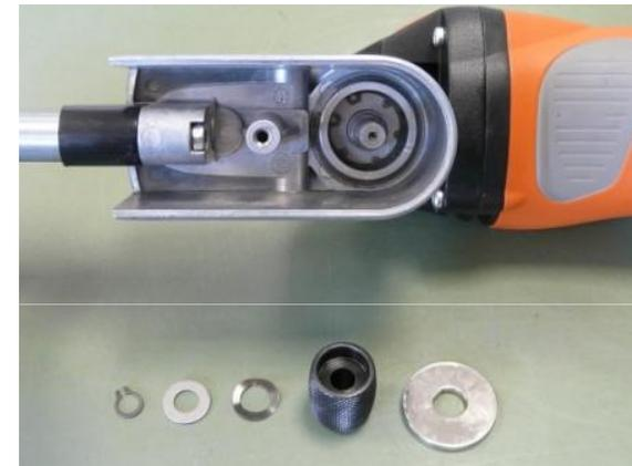
1. Desserrer la vis du recouvrement et enlever le recouvrement
