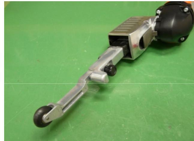
1. Placer le bras de ponçage et le fixer avec la vis de réglage
