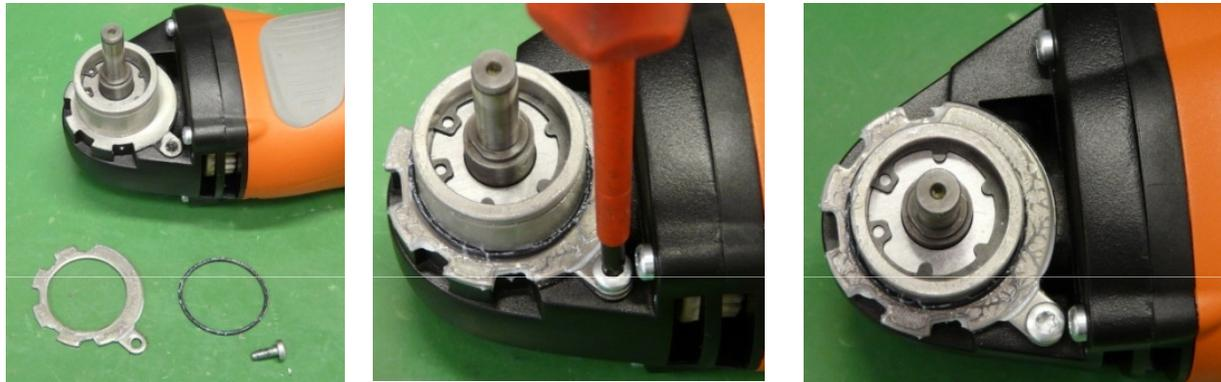
1. Placer le disque et le joint torique sur le boîtier d'engrenage et visser
