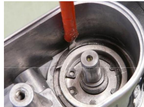
1. Placer l'adaptateur de ponçage pré-assemblé sur le boîtier d'engrenage de la machine – appliquer au préalable de la pâte Molykote sur la surface d'appui de l'adaptateur de ponçage (cercles jaunes)
