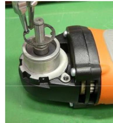
1. Presser le roulement à billes et la roue dentée sur la broche
