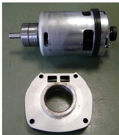
Appuyer avec précaution sur le moteur pour le sortir du palier intermédiaire.
