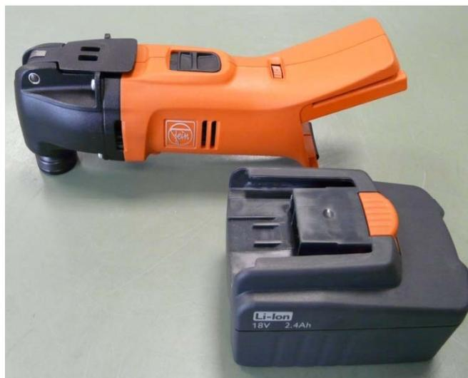
Presser le bouton de déverrouillage et retirer la batterie.
