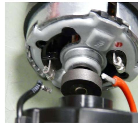
Monter le ressort d'enclenchement sur le système électronique.
