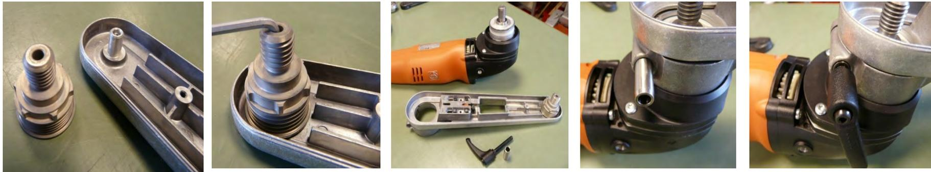
5. Introducir el árbol de accionamiento integrado en la parte superior de la carcasa y atornillarlo
