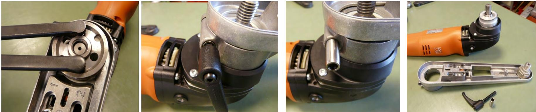
7. Presionar el botón de retención para bloqueo de husillo de eje en la caja de engranajes, soltar la rueda de correa con el aprietatuercas de dos agujeros y desatornillar completamente
