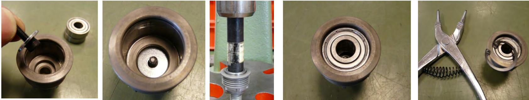
1. Insertar el tornillo de fijación con la arandela y la arandela de seguridad en el árbol de accionamiento
