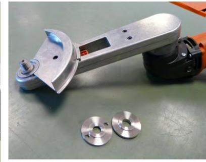
1. Colocar la parte inferior de la carcasa premontada y fijarla con tornillos
