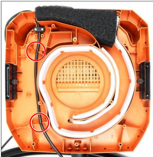
4. 将电线放入导向装置中。
