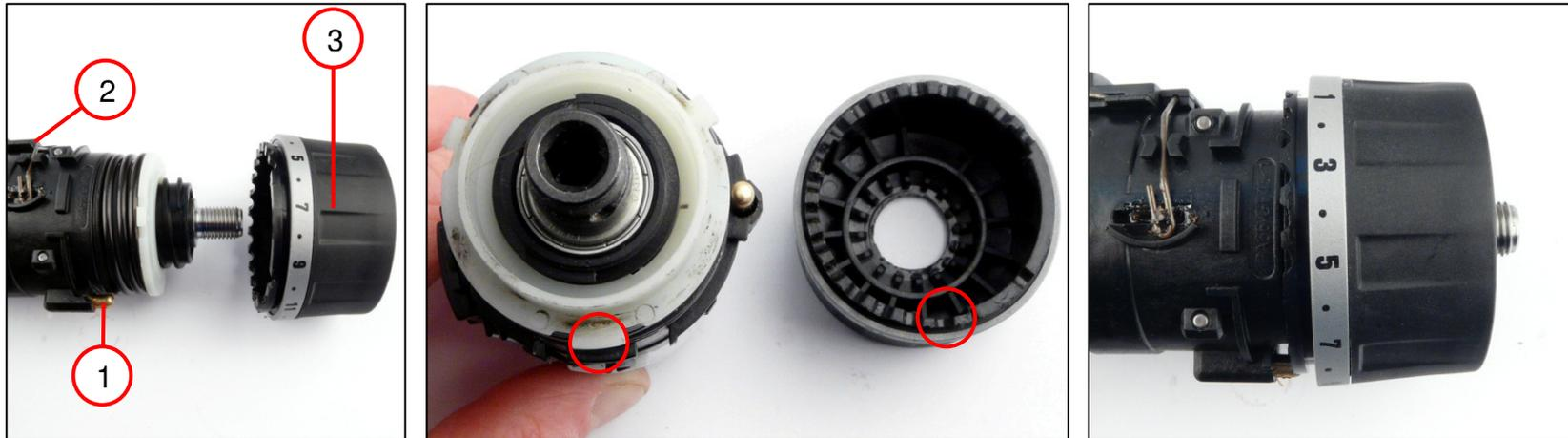
1. Den Bolzen mit Feder (1) einsetzen.
