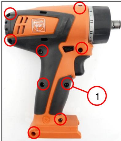
1. Das Motorgehäuse aufsetzen.
