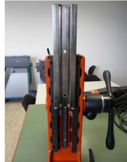
**Positionner les rails de guidage sur le bâti et les fixer (SERRER LEGEREMENT LES VIS).
