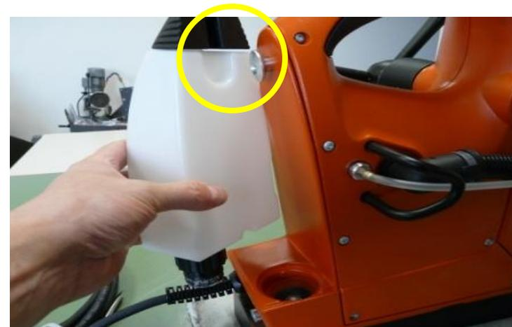
**Soulever le réservoir de réfrigérant avec un tournevis et le tirer vers le haut jusqu'à ce que le réservoir sorte du système de blocage à l'extrémité supérieure. (cercle jaune)
