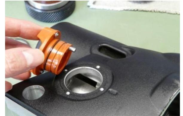
**Desserrer la vis de fixation de la griffe d'accouplement et retirer la griffe d'accouplement – idéalement en position d'interrupteur 1ère vitesse
