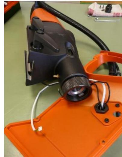
**Démontez le cache électronique avec la pompe de refroidissement et les tuyaux**
