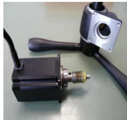
**Desserrer les vis de la fixation du moteur**
