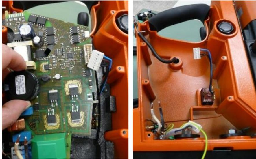
**Une fois que toutes les liaisons allant du circuit imprimé aux interrupteurs et autres composants ont été séparées, le circuit imprimé peut à présent être sorti de la mousse ou du support de perçage.**
