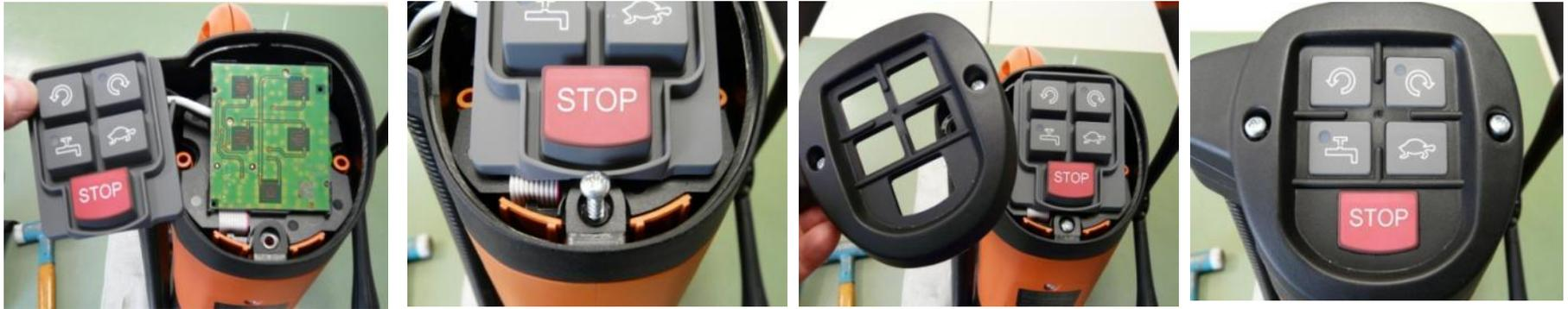
**Insérer le système électronique de touches dans le support et placer le tapis sensible en caoutchouc**
