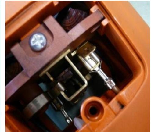
**Insérer les pôles d'inducteur dans le carter moteur, les câbles doivent pour cela être introduits à travers le carter moteur**
