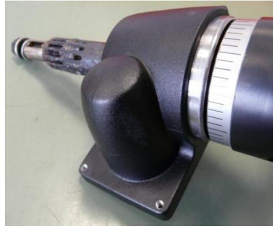
**Pousser le boîtier sur le roulement par de légers coups de marteaux jusqu'à la butée**
