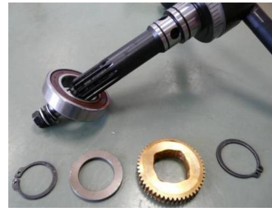
**Retirer la roue hélicoïdale de l'arbre d'entraînement**
