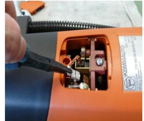
**Retirer le système électronique du moteur du carter moteur**
