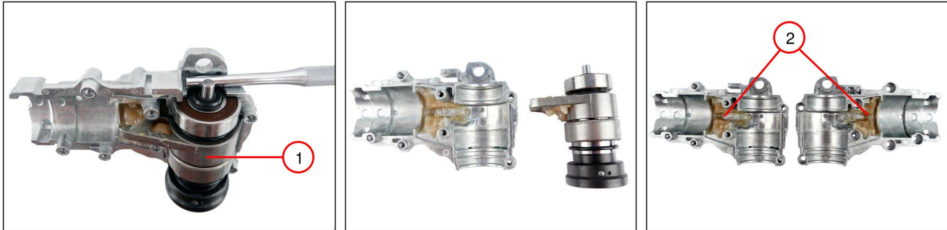
1. Die Spanneinheit (1) entfernen.
