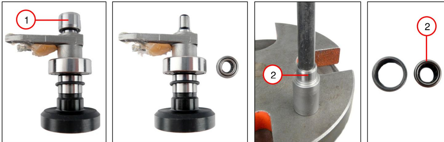
1. Die Buchse mit Nadelhülse (1) entfernen.
