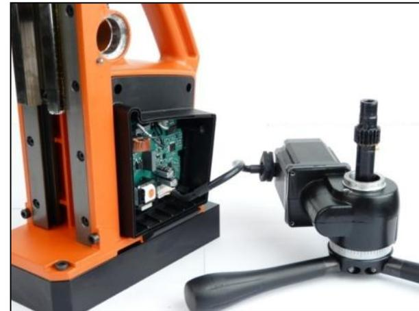
1. Die vier Schrauben (1) lösen und den Deckel abnehmen.
