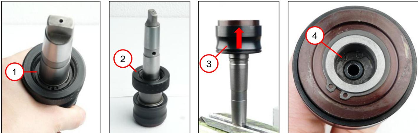
1. Den Sicherungsring (1) entfernen.
