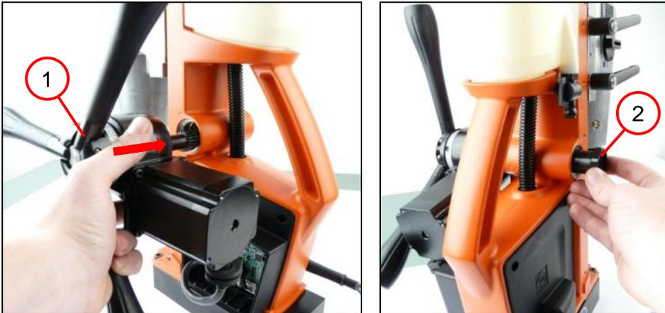
1. Das Drehkreuz mit dem Motor (1) aufstecken.
