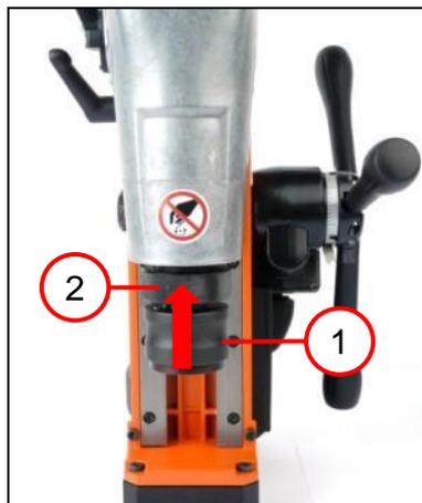
1. Das Bohrfutter (1) nach oben in die Aufnahme schieben.
