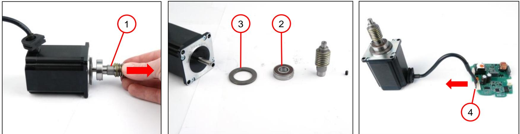
1. Die Schraube (1), das Rillenkugellager (2) und die Scheibe (3) herausziehen.
