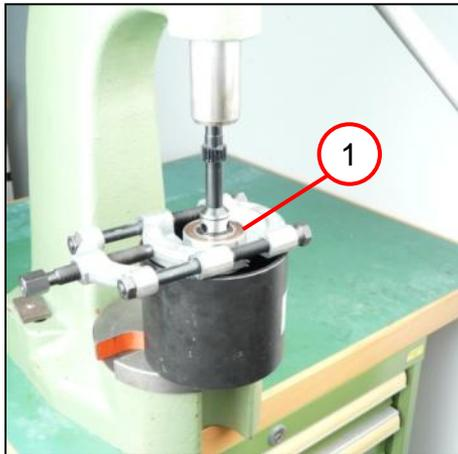
1. Das Rillenkugellager (1) abziehen.
