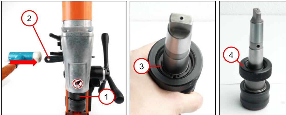
1. Die Mutter (1) lösen [Linksgewinde].
