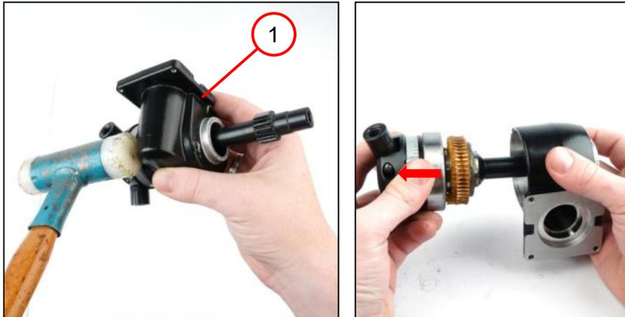
1. Das Gehäuse (1) mit leichtem Klopfen lösen und abziehen.
