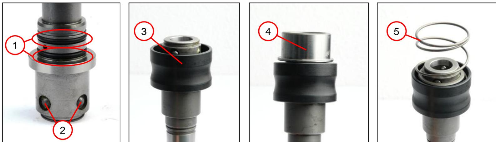
1. Die zwei Dichtringe (1) auf der Welle positionieren.
