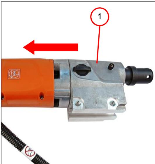
1. 将齿轮箱（1）放到钻孔马达上。
