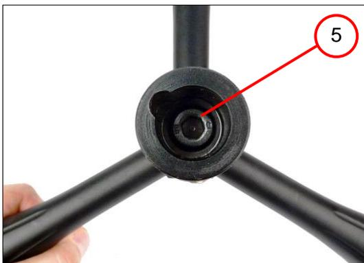
6. 拧入圆柱头螺栓（5）[8.0 Nm  $\pm$ 0.5 Nm]。
