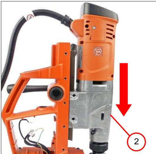
2. 将钻孔马达 (2) 推入导向装置。
