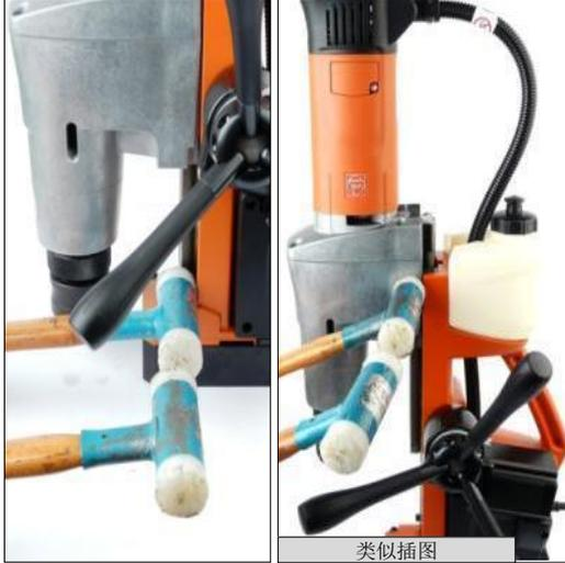
7. 用力敲击导向装置（1），使导向板之间没有间隙。
