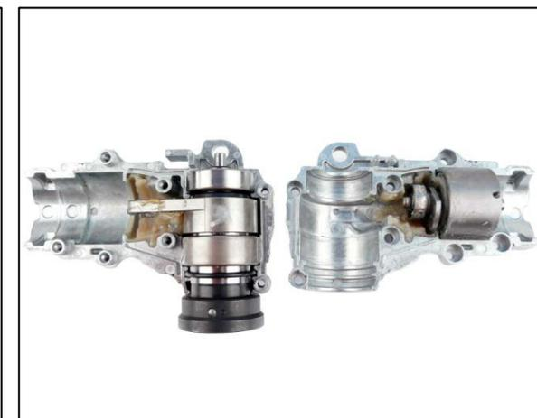
1. Desenroscar los siete tornillos con arandela de seguridad (1).
