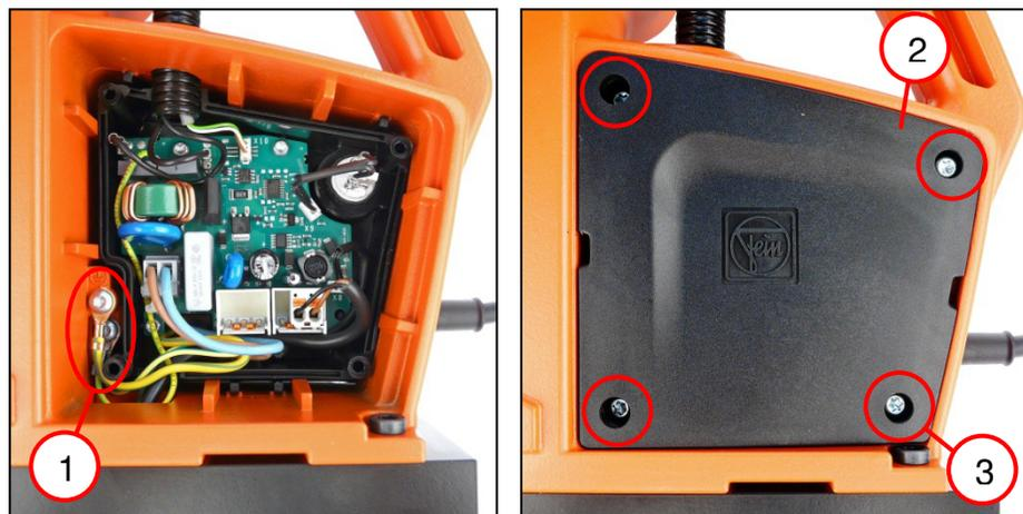
1. Conectar todos los cables de conexión según el esquema de conexiones.
