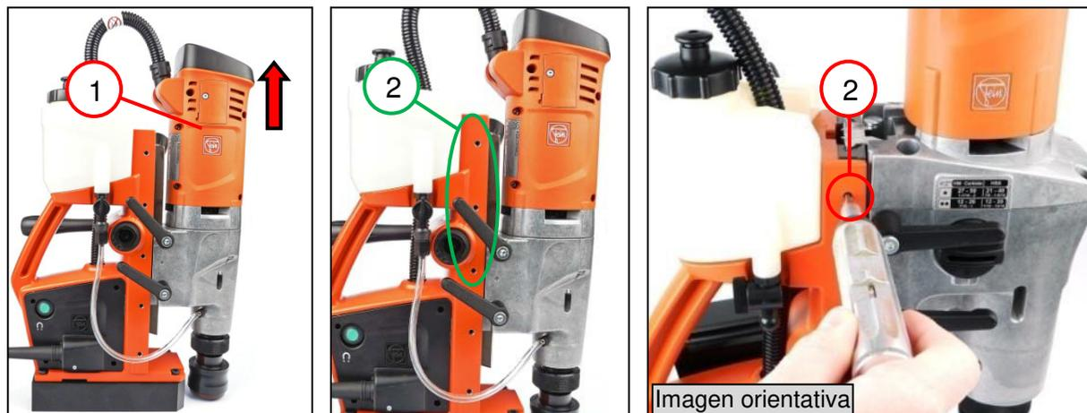
1. Desplazar el motor de perforación (1) a la posición superior.
