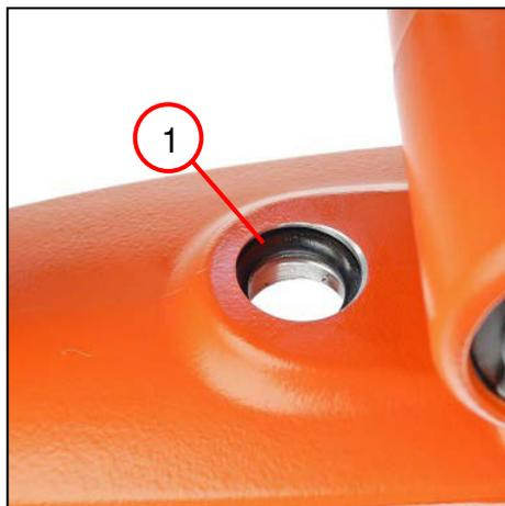
1. Lubricar la junta toroidal (1) con grasa.
