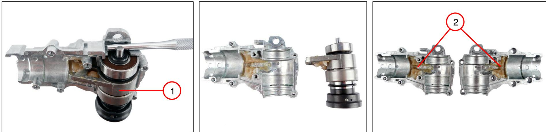
1. Die Spanneinheit (1) entfernen.
