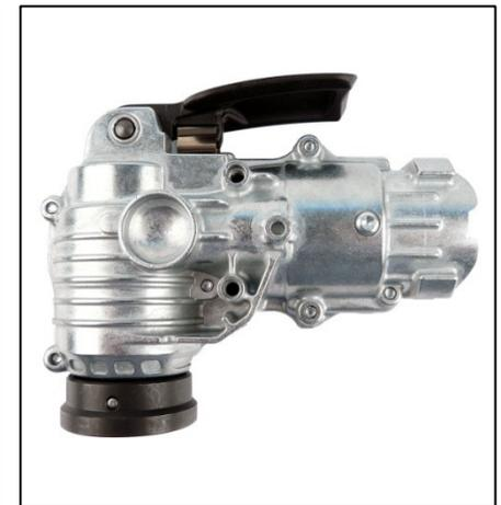
1. Das Kupplungsteil (1) aus dem Getriebegehäuse entfernen.
