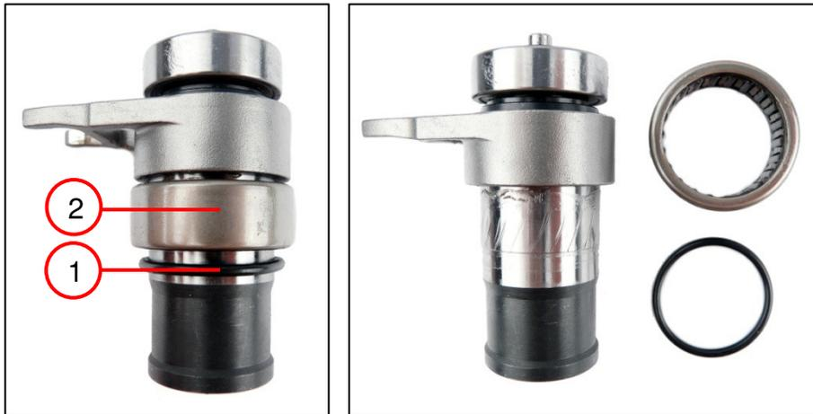
1. Den Dichtring (1) entfernen.
