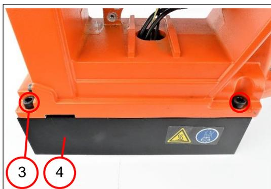
3. Svitare le due viti a testa cilindrica [M8x22] (3).
