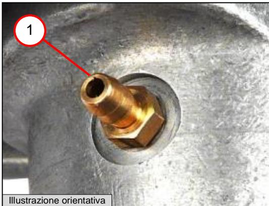
3. Montare il raccordo flessibile (1) [1,8 Nm  $\pm$ 0.25 Nm].
