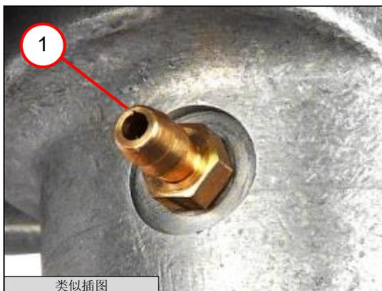
2. 拧出软管连接装置（2）。
