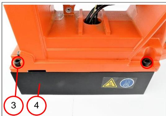
3. 拧出两个圆柱头螺栓 [M8x22] (3)。
