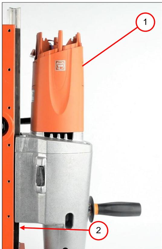
1. 将电机（1）抬入导向装置。
