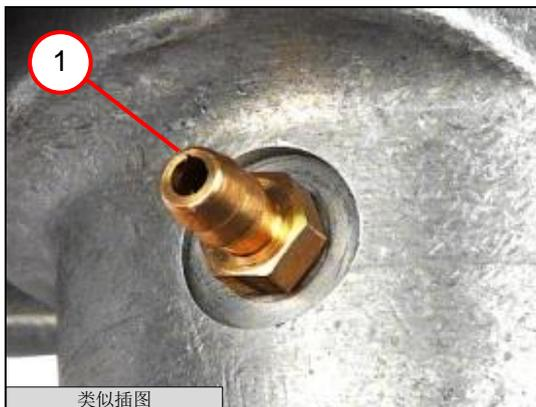
3. 安装软管连接装置 (1) [1.8 Nm  $\pm$ 0.25 Nm]。
