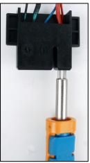
1. Die Kabel (1) lösen.
