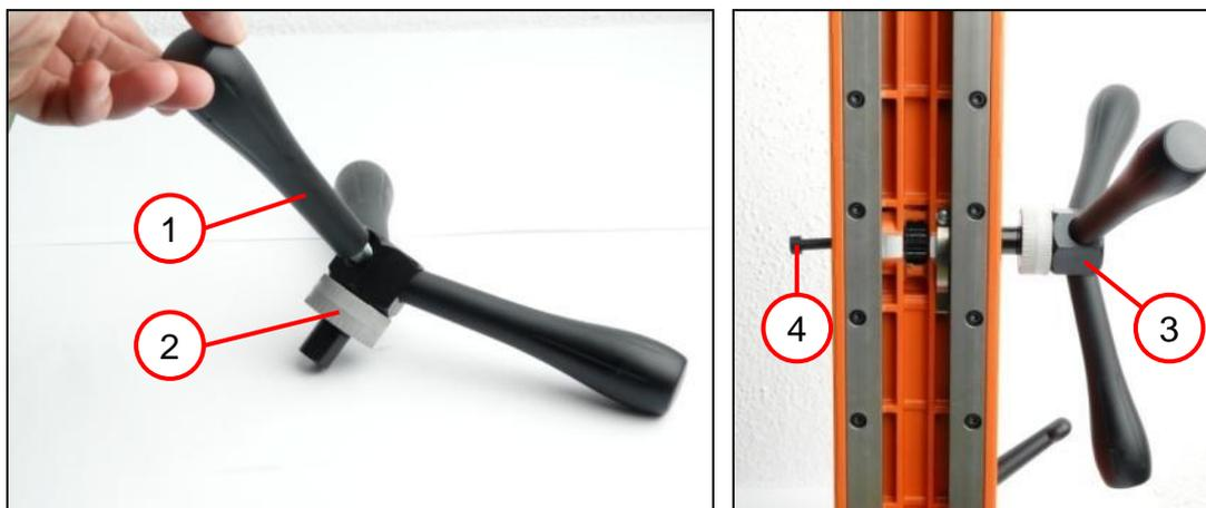
1. Atornillar las empuñaduras (1) en la pieza de conexión.
