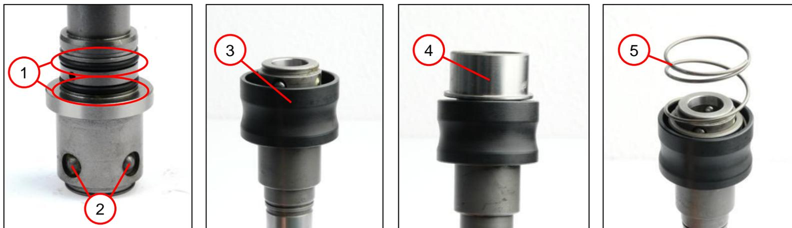
1. Posicionar las dos juntas toroidales (1) en el árbol.
