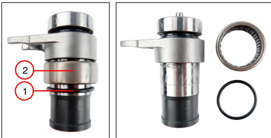
1. Retirer la bague d'étanchéité (1).
