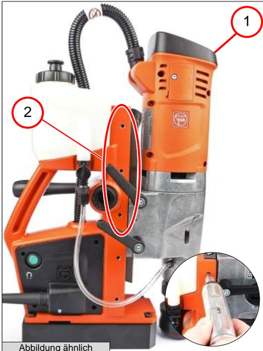
1. Den Bohrmotor (1) in die obere Position fahren.
