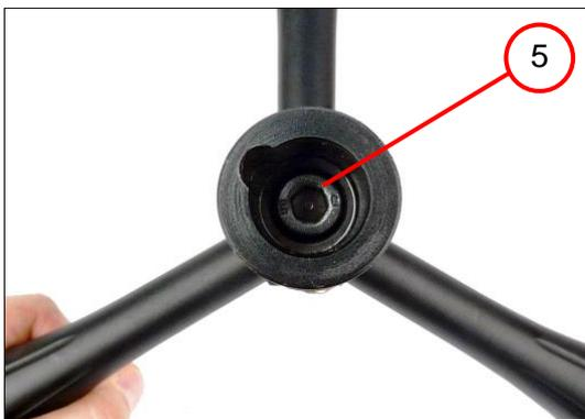
6. Die Zylinderschraube (5) eindrehen [8.0 Nm  $\pm 0.5$  Nm].
