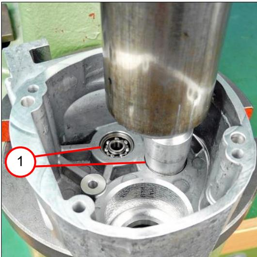
1. Die Rillenkugellager (1) einpressen.
