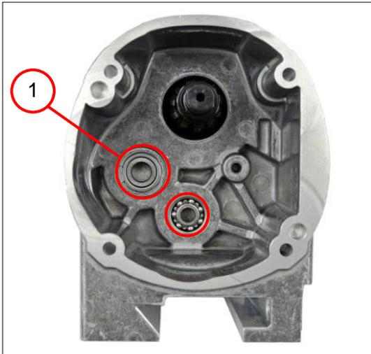
8. Die zwei Rillenkugellager (1) entfernen.
