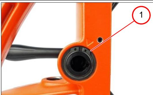
1. Den Sicherungsring (1) entfernen.
