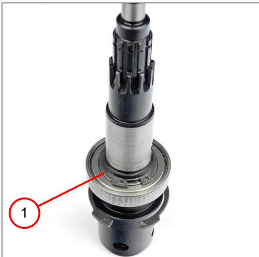
1. Den Sicherungsring (1) entfernen.
