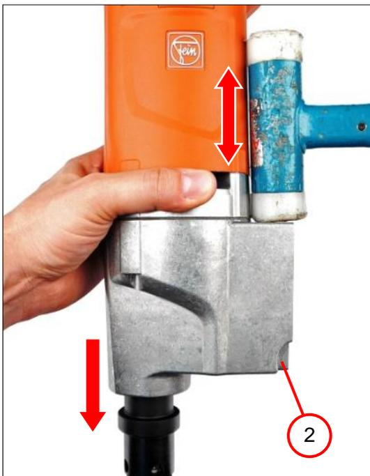
2. Das Getriebegehäuse (2) entfernen.
