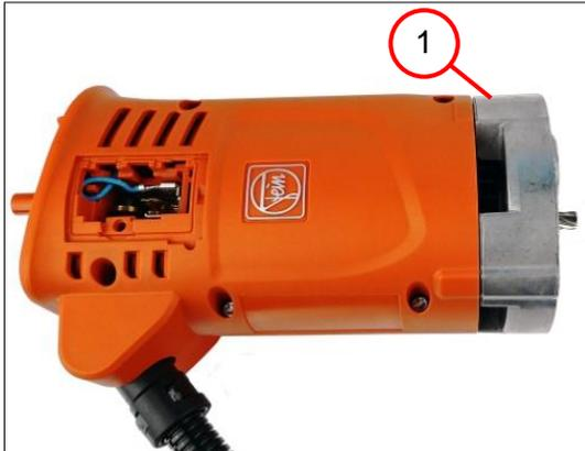
1. Das Zwischenlager (1) entfernen.
