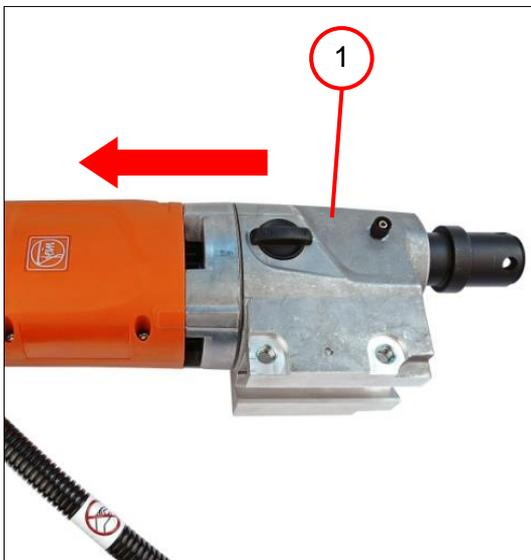
1. Das Getriebegehäuse (1) auf den Bohrmotor setzen.
