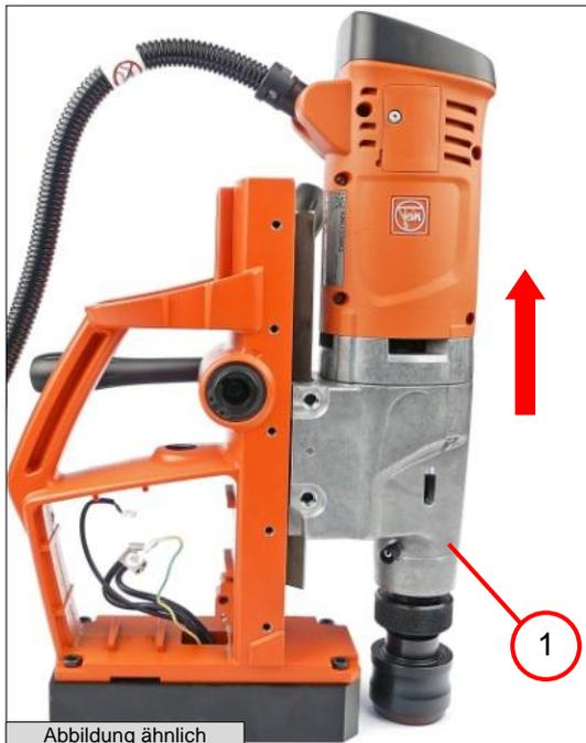
4. Den Bohrmotor (1) aus der Führung heben.
