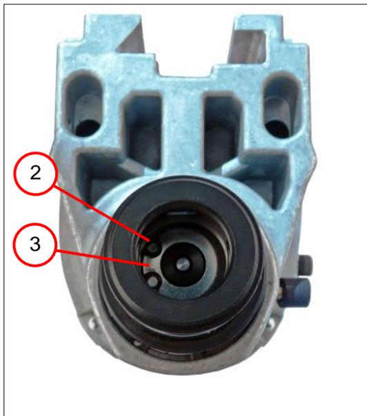
7. Den Sicherungsring (2) demontieren.
