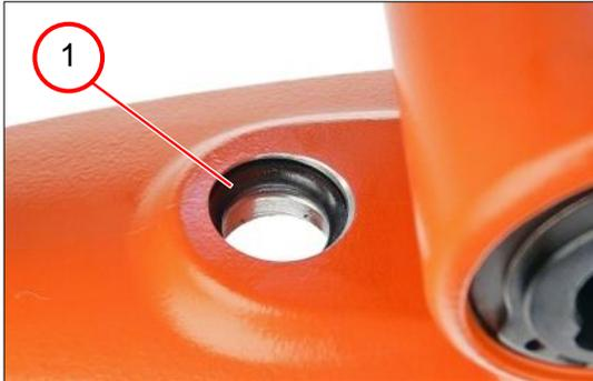
1. Den Dichtring (1) entfernen.
