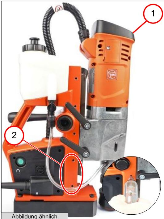
4. Den Bohrmotor (1) in die obere Position fahren.
