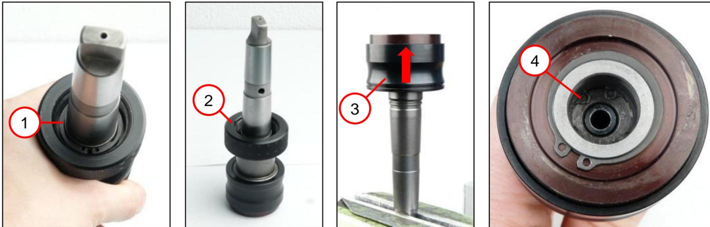
1. Den Sicherungsring (1) entfernen.
