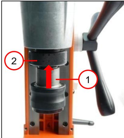
1. Das Bohrfutter (1) nach oben in die Aufnahme schieben.
