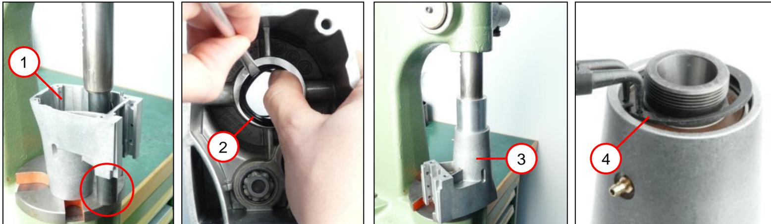
1. Die beiden Rillenkugellager in das Gehäuse (1) einpressen.
