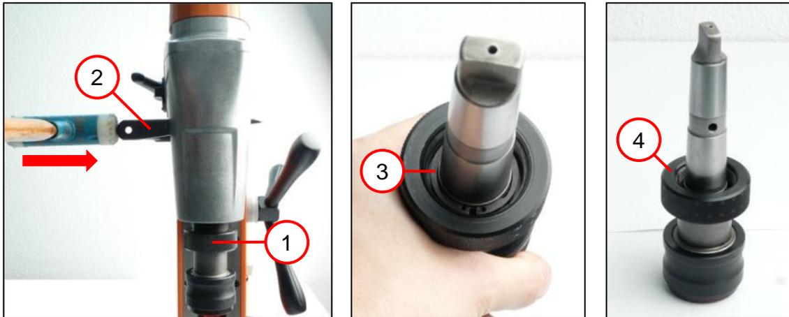
1. Die Mutter (1) lösen [Linksgewinde].
