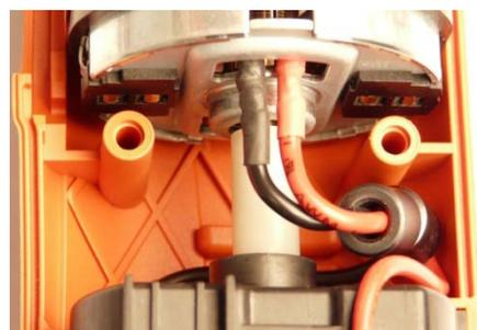
Motor nuevo con casquillos de ferrita y nuevo sistema electrónico con encapsulado
