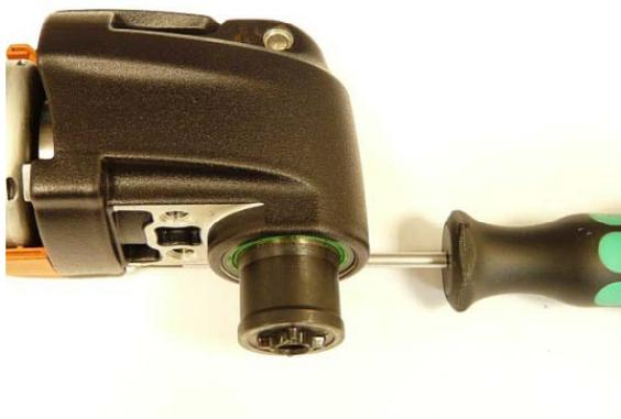
1. Atornillar el cabezal de engranaje con ambos tornillos en la parte inferior de la carcasa.
