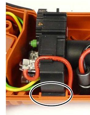
1. Insertar el motor/unidad de engranaje premontados y el sistema electrónico en la parte inferior de la carcasa.
