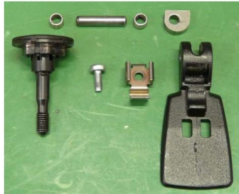
Auf Grund von Vorgaben für die Einpresskraft der Antriebswelle, welche nach der Reparatur nicht gewährleistet werden kann, wird der Getriebekopf nur als komplette Baugruppe getauscht bzw. als Ersatzteil angeboten.
