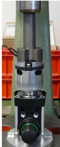
1. Antriebswelle so drehen, dass die Gabel im Getriebe mittig ausgerichtet ist.
