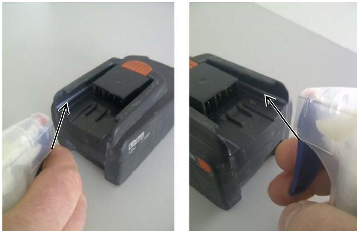
1. Beide Führungen am Akku mit Finish-Sprühwachs einsprühen und trocknen lassen.
