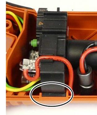
1. Vormontierte Motor/ Getriebeeinheit und Elektronik in Gehäuseunterseite einlegen.
