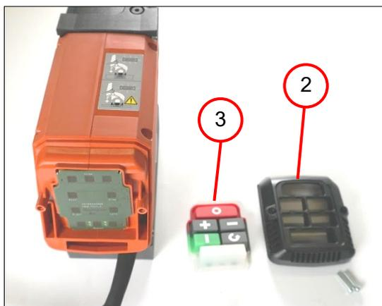
2. Placer l'insert d'interrupteur (2).
