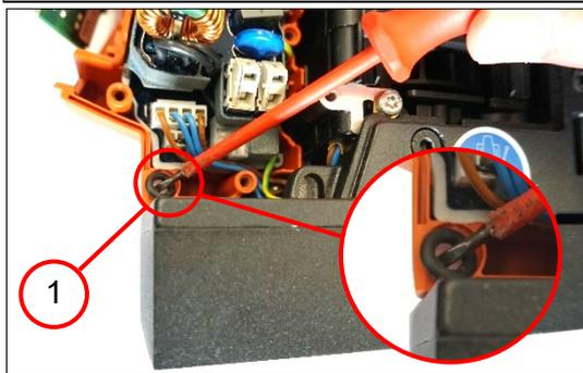
3. Placer la bague d'étanchéité (1).
