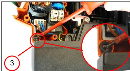
3. Retirer la bague d'étanchéité (3).
