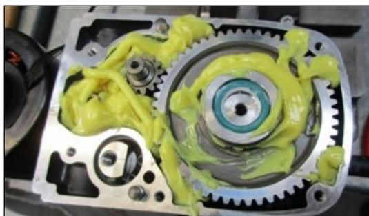
8. Remplir l'engrenage de graisse.
