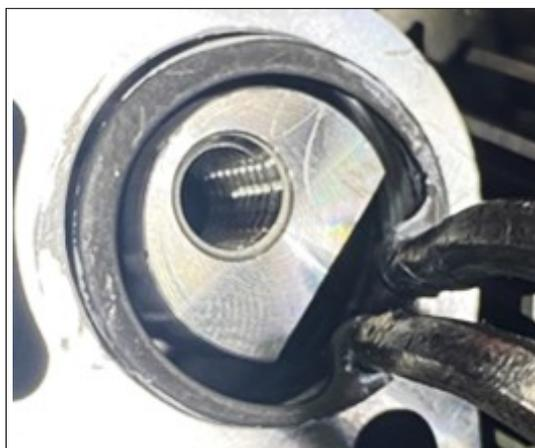
3. Placer le circlip (3).
