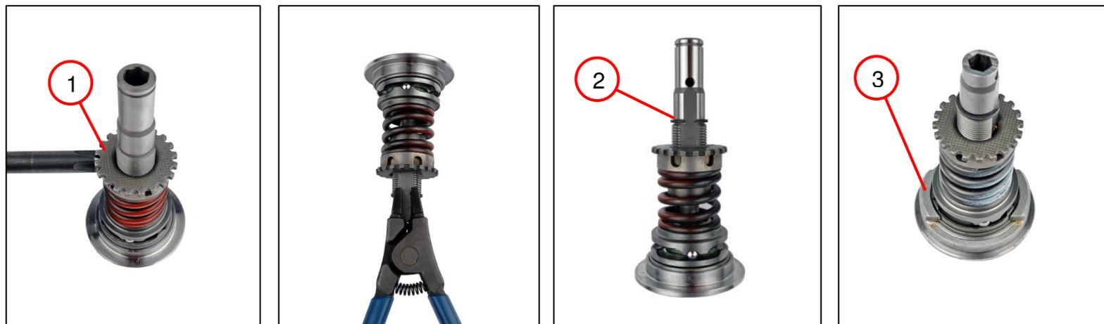
1. Monter la bague de réglage (1) [filetage à gauche].
