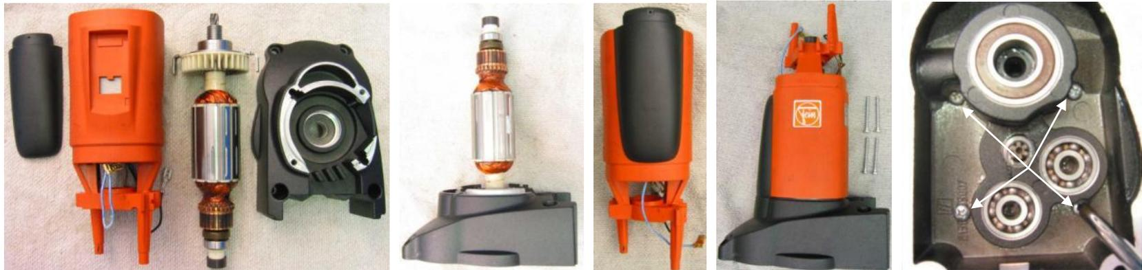
1. Vormontierten Anker (40) in vormontiertes Zwischenlager (90) einsetzen.
