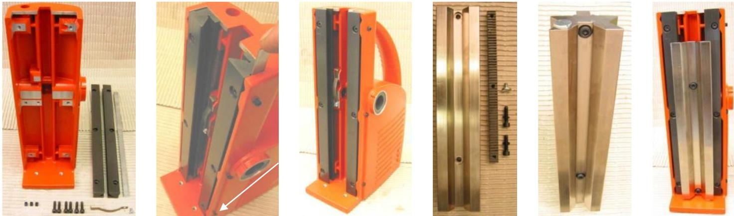
1. Führungsschienen (720) mit Zylinderschrauben (730) leicht anlegen. Druckleiste (710) hinter die Führungsschiene schieben. Gewindestifte (760) leicht anlegen.
