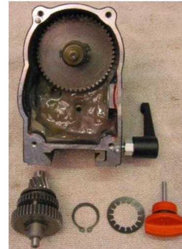
1. Zylinderschrauben (450) entfernen und äußeres Lager (280) abnehmen
