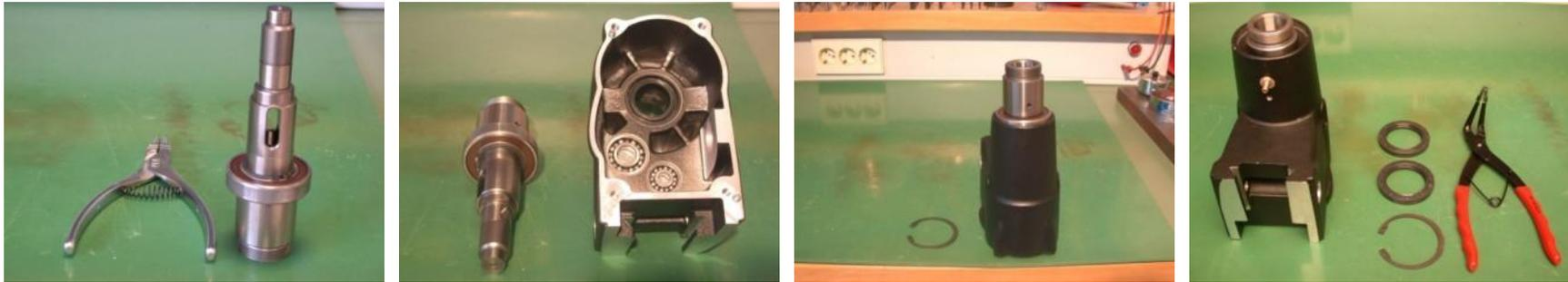
1. Lager(250) auf Bohrwelle(280) aufpressen und mit Sicherungsring(255) fixieren
