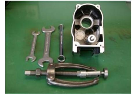
1. Sicherungsring(310) und Zahnrad(300) entfernen, Paßfeder(290) herausnehmen
