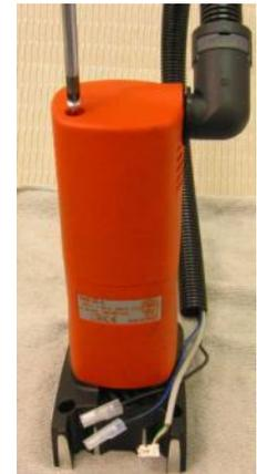
1. Bürstenhalter (180) mit Schrauben (190) an Motorgehäuse (10) mit 1,2 Nm befestigen.
