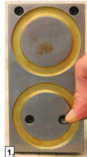
1. Visser le pied magnétique [\(880\)](#) avec la vis à tête cylindrique [\(890\)](#) et la rondelle d'arrêt [\(770\)](#) sur le carter.
