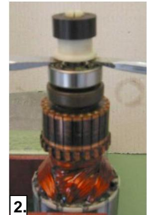
1. Déposer la rondelle Nilos (135). Retirer le roulement radial à billes (70) avec la bague d'étanchéité (80) sur l'induit (40) avec l'extracteur.
