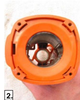
1. Placer le bloc de pôles (20) dans le carter moteur (positionner correctement) et presser avec la douille (E/I/H/59,5/54/65).
