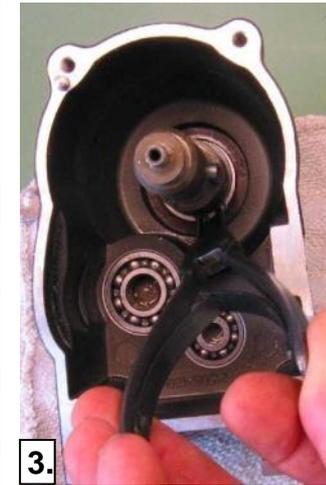
1. Presser le roulement à billes rainuré **(300)** dans le palier extérieur **(280)** et bloquer avec la bague d'arrêt **(310)**.
