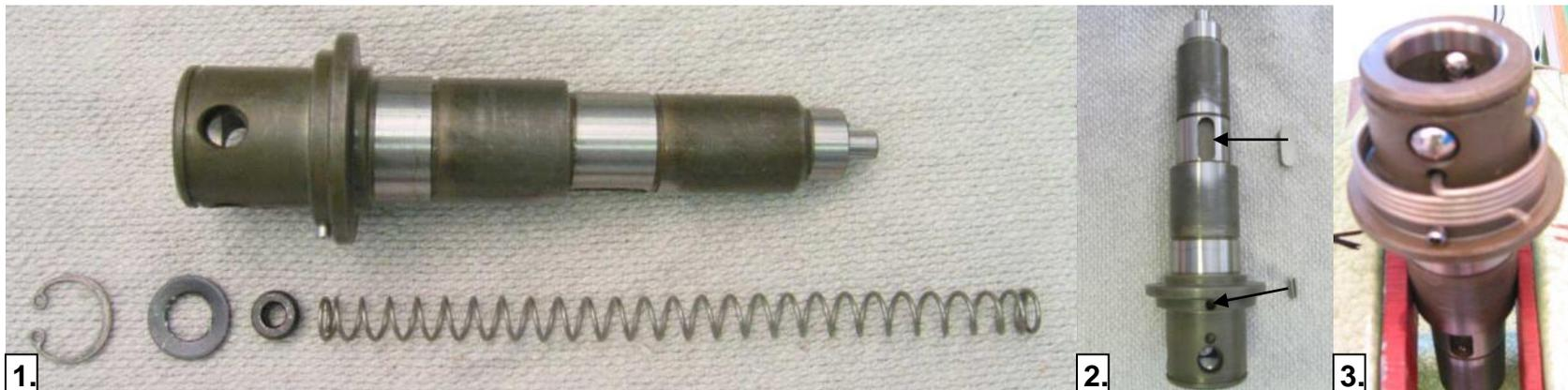
1. Enficher le ressort de pression (330), la douille (340) et la rondelle (350) sur l'arbre de perçage (320). Placer la bague d'arrêt (360) sur l'arbre de perçage. Presser toutes les pièces dans l'arbre de perçage (320) avec le boulon jusqu'à ce que la rondelle d'arrêt soit verrouillée.
