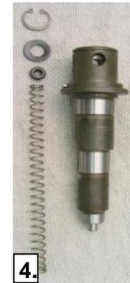
1. Déposer la rondelle d'arrêt **(410)** et tirer la douille de serrage **(400)** vers l'avant.
