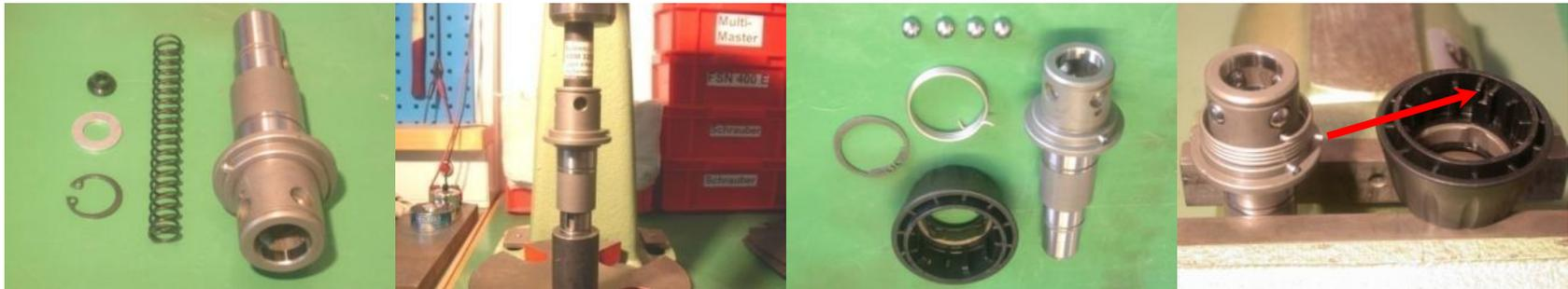
1. Federlagerung für Zentrierstift in Bohrwelle einbauen
