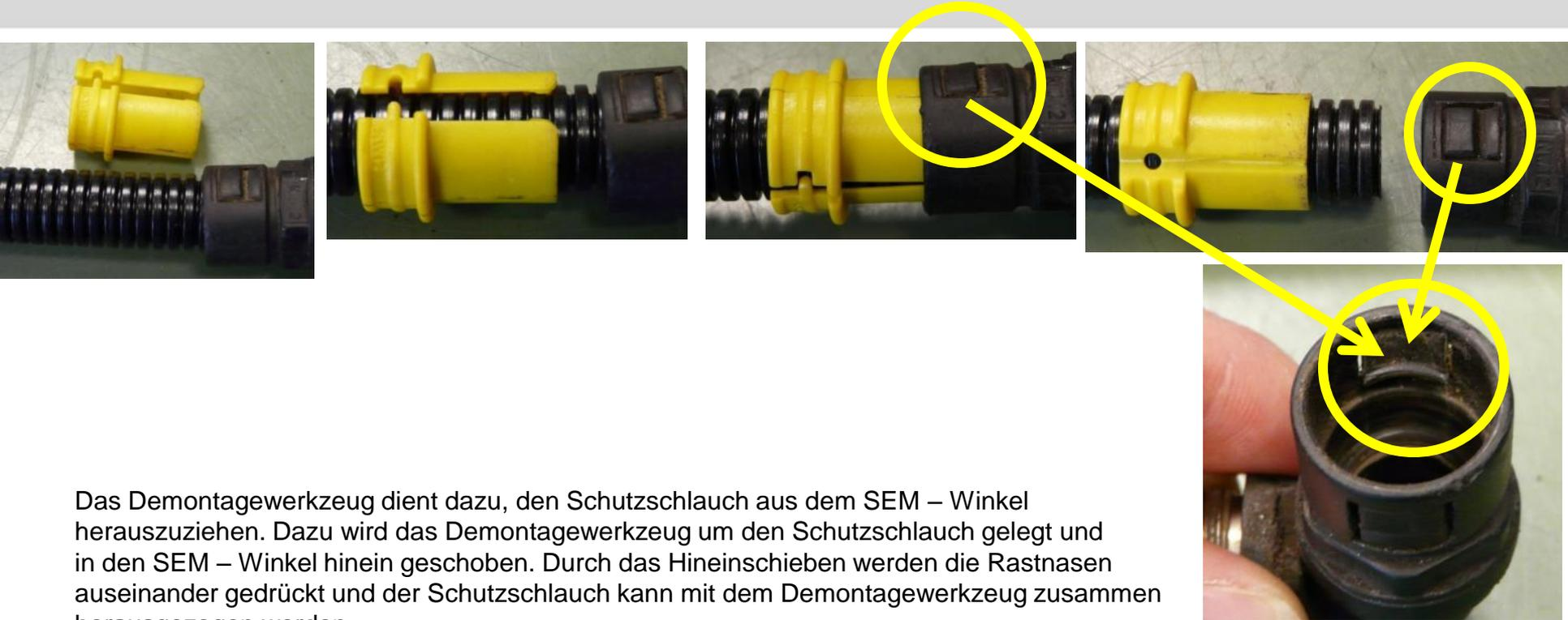
Das Demontagewerkzeug dient dazu, den Schutzschlauch aus dem SEM – Winkel herauszuziehen. Dazu wird das Demontagewerkzeug um den Schutzschlauch gelegt und in den SEM – Winkel hinein geschoben. Durch das Hineinschieben werden die Rastnasen auseinander gedrückt und der Schutzschlauch kann mit dem Demontagewerkzeug zusammen herausgezogen werden.
