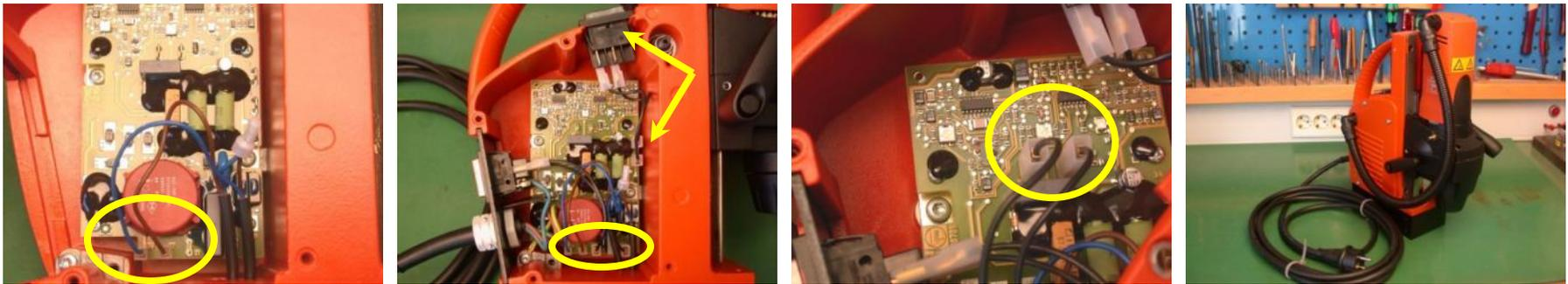
1. Platine einbauen und Magnetfuß anschließen (Kreis)
