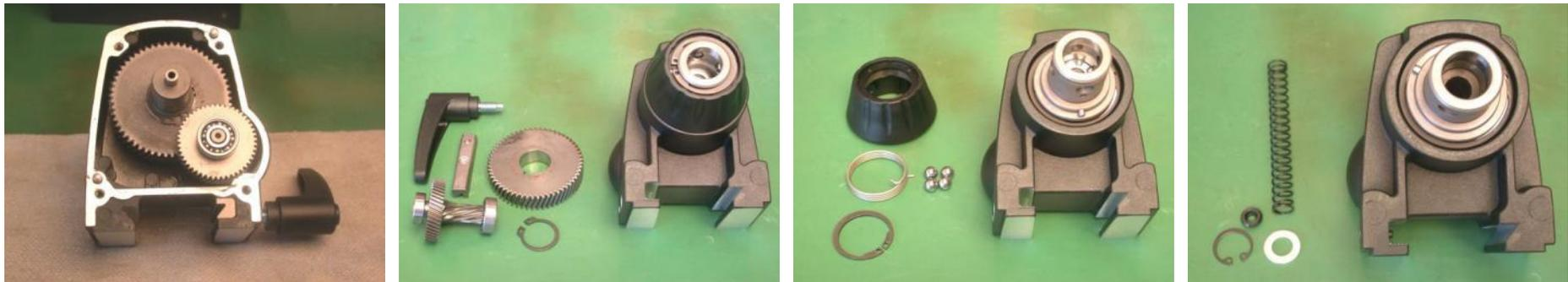
1. Spannhebel, Einlegeteil Sicherungsring, Zahnrad und Stirnradwelle entfernen
