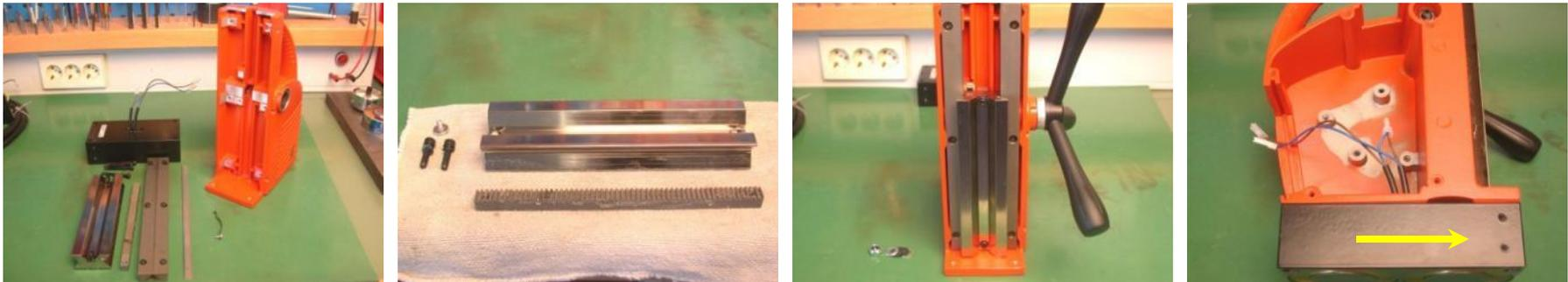
1. Zahnstange auf Motorführung aufschrauben
