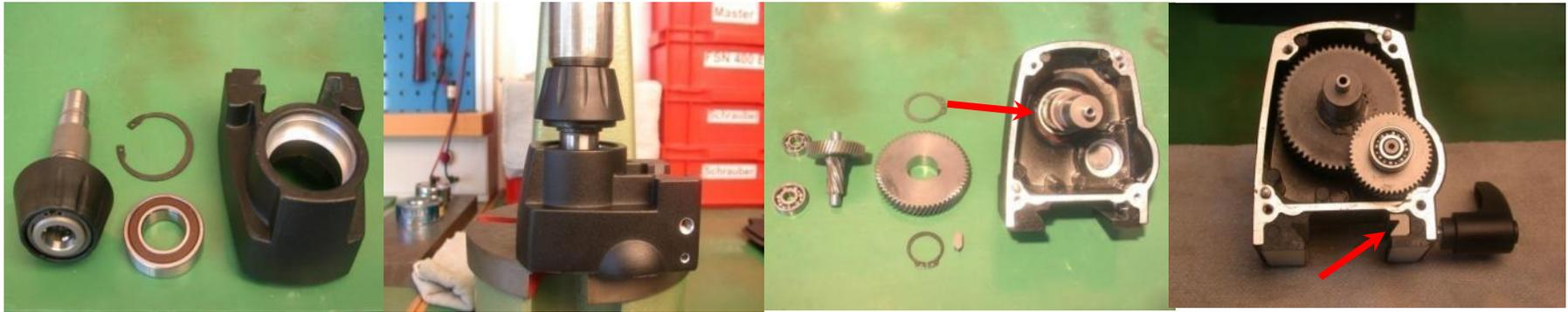
1. Kugellager einpressen, Sicherungsring einbauen
