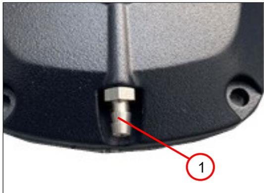
1. Colocar y atornillar la boquilla para conexión de mangueras (1).
