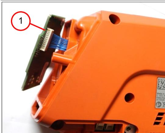
1. Colocar el sistema electrónico (1).
