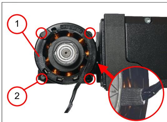
3. Colocar la carcasa del motor (1)
