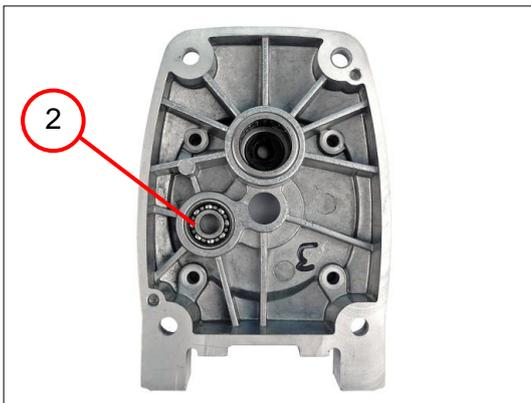
4. Das Rillenkugellager (2) entfernen.
