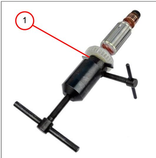
1. Das Rillenkugellager (1) entfernen.
