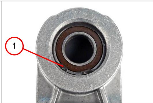
1. Den Sicherungsring (1) entfernen.
