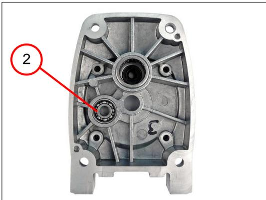
4. Das Rillenkugellager (2) einpressen.
