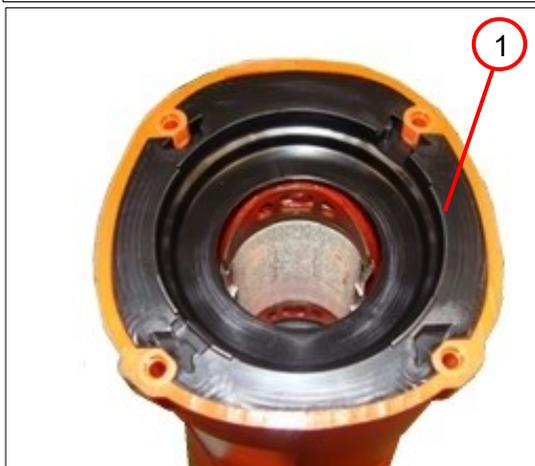
1. Colocar el anillo conductor de aire (1).
