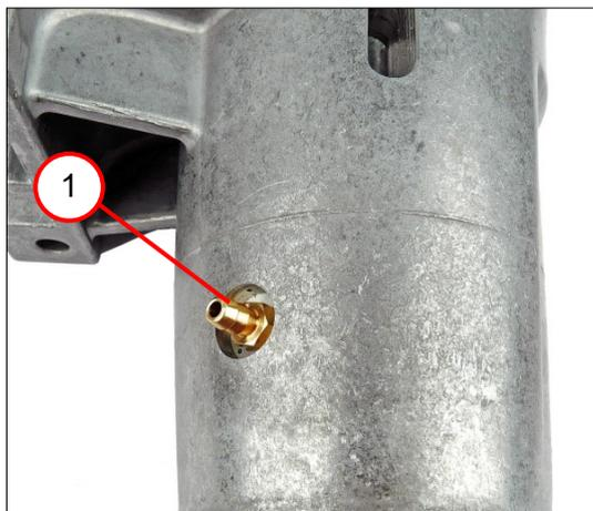
2. Retirar la boquilla para conexión de mangueras (1).
