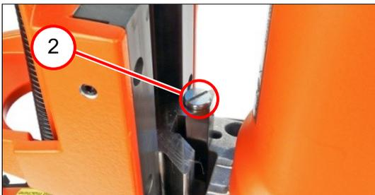
4. Enroscar el tornillo (2) [2,7 Nm  $\pm 0,3$  Nm].
