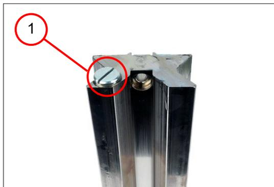
7. Enroscar el tornillo de cabeza plana (1) [1,2 Nm  $\pm 0,15$  Nm].
