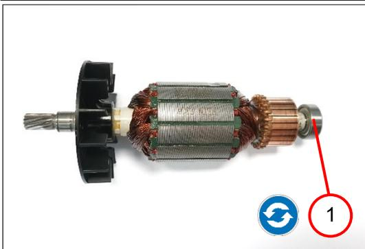
1. Das Rillenkugellager (1) entfernen.
