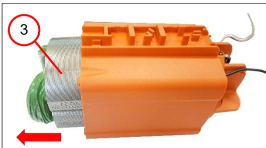
3. Den Stator (3) entfernen.
