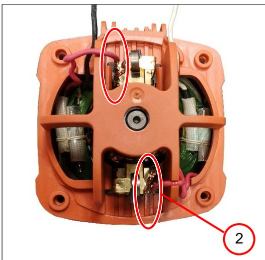
2. Die zwei Kabel (2) nach Anschlussplan anschließen.
