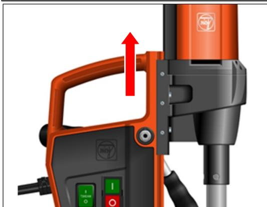
1. Den Bohrmotor nach oben fahren.
