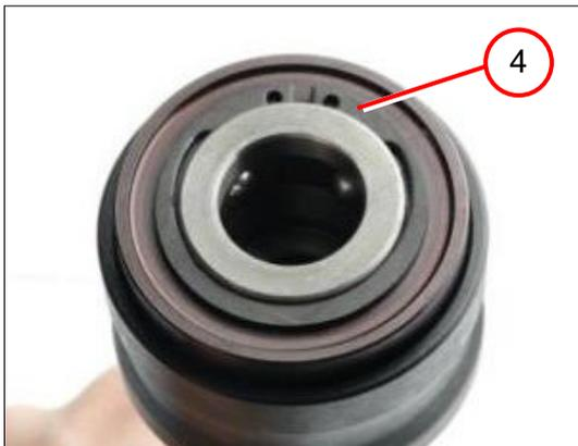
6. Den Sicherungsring (4) entfernen.
