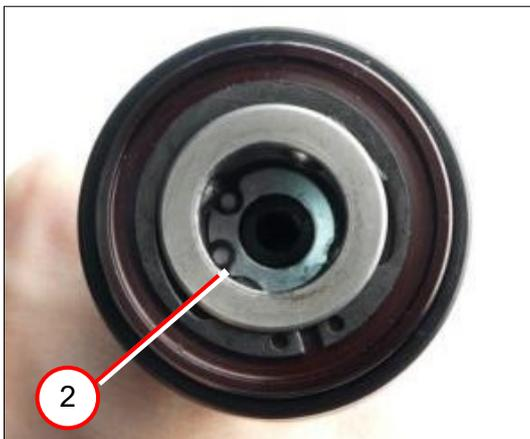
2. Den Sicherungsring (2) entfernen
