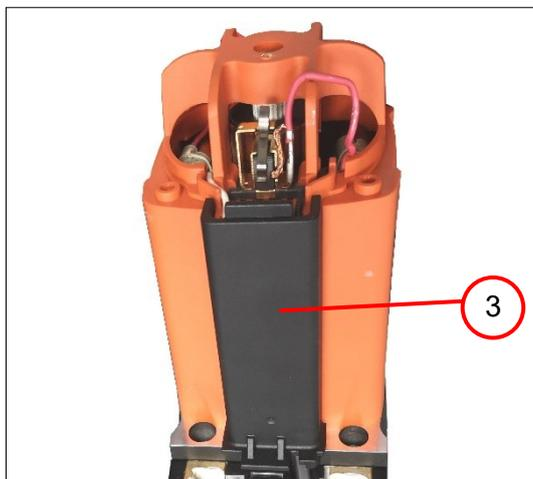
4. Den Kabelkanal (3) entfernen.
