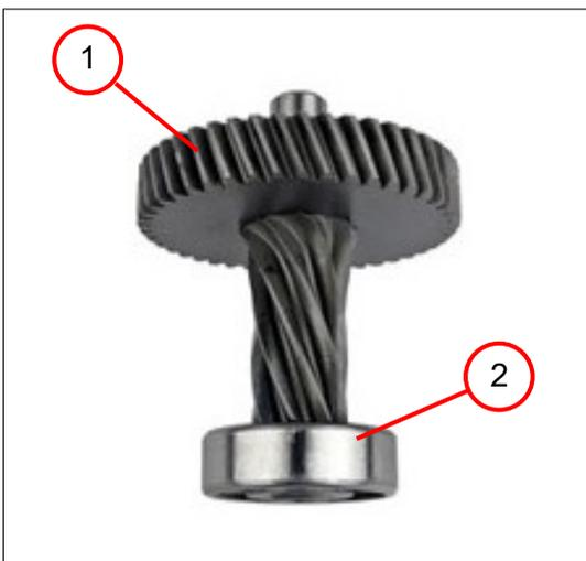
2. Das Rillenkugellager (2) abziehen.
