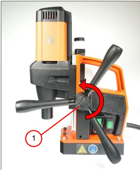
1. Die Schraube (1) lösen und das Drehkreuz entfernen.
