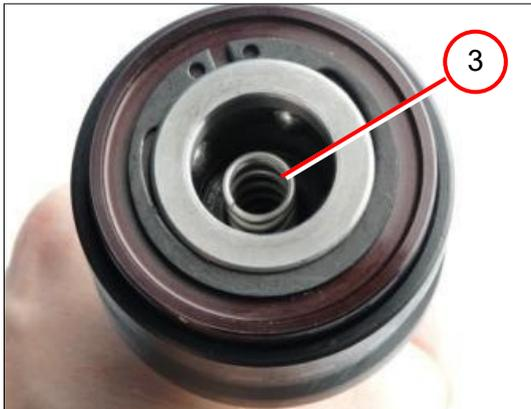
5. Die Spiralfeder (3) entfernen.
