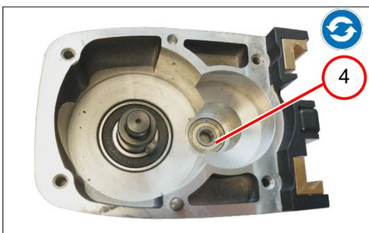
5. Das Rillenkugellager (4) entfernen.
