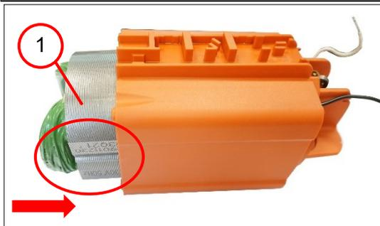
1. Mettre en place le stator (1) dans la bonne position.
