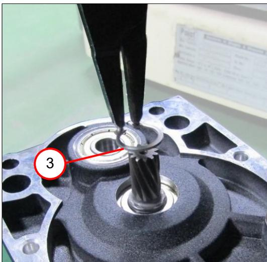
5. Placer le circlip (3).
