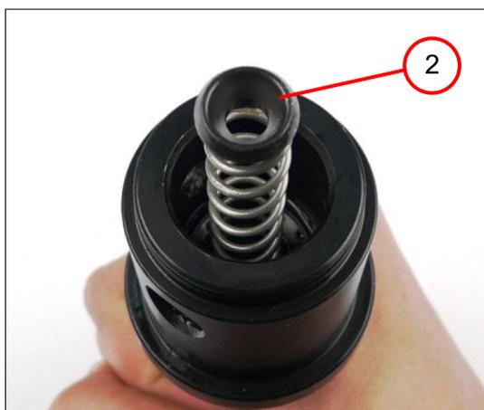
2. Placer la bague d'étanchéité (2).
