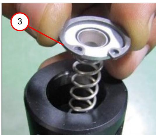
3. Placer le circlip (3).
