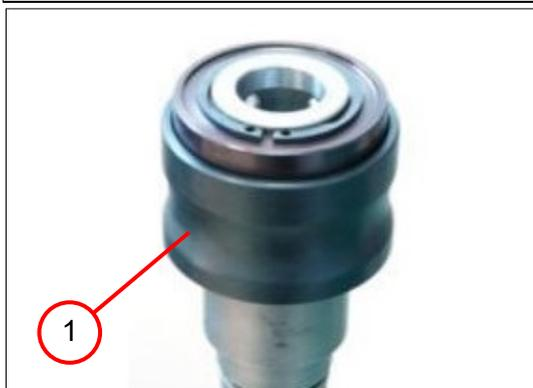
1. Desplazar hacia arriba el manguito de sujeción (1) y sujetarlo.
