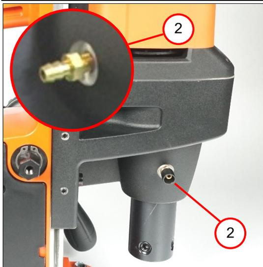
1. Apretar la boquilla para conexión de mangueras (1).
